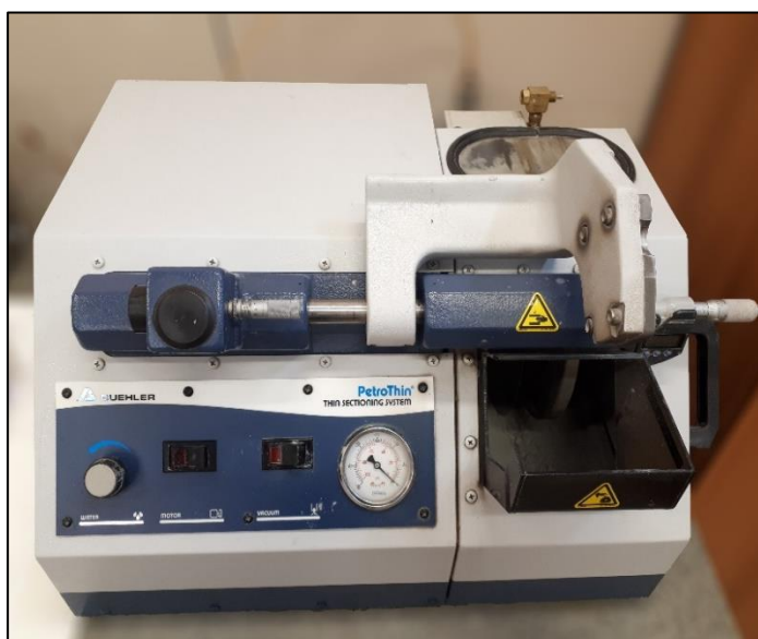
Slika 7: Uređaj Buehler Petro Thin koji se koristi za sečenje uzorka stene
