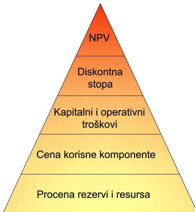
Slika 6.1. Dijagram faza analize neto sadašnje vrednosti u rudarskim projektima (Morley, Snowden, Day 1999)
