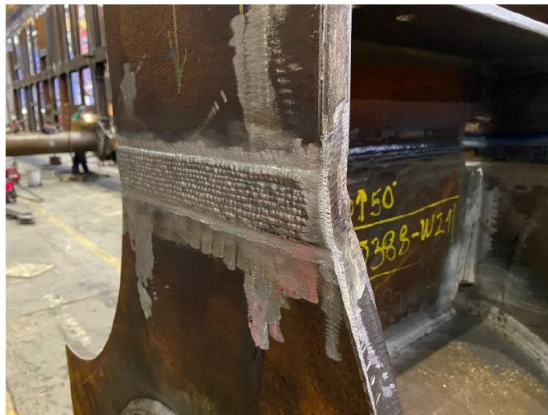
Slika 18. Primer zavarenog spoja
