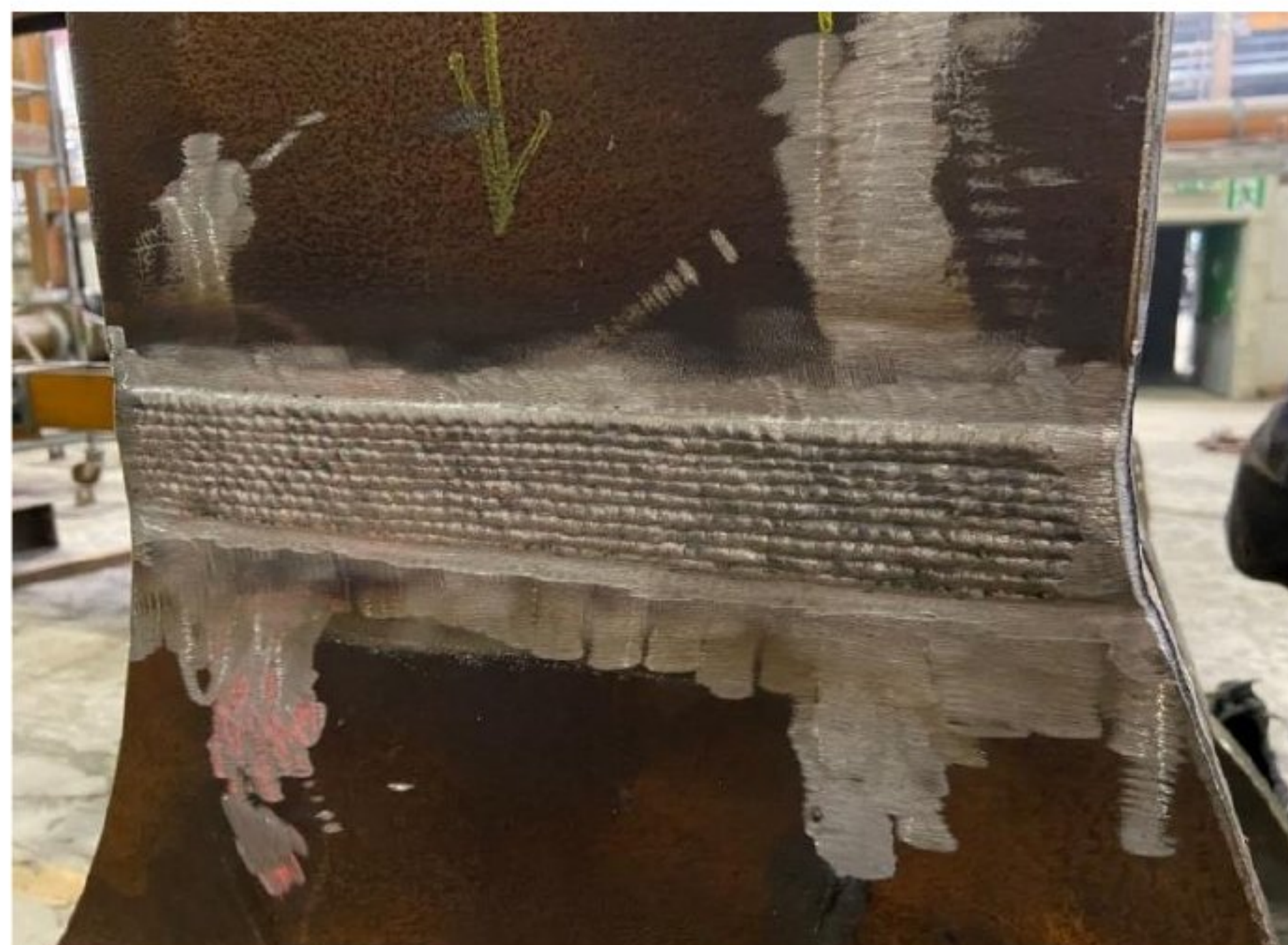
Slika 19. Primer zavarenog spoja
