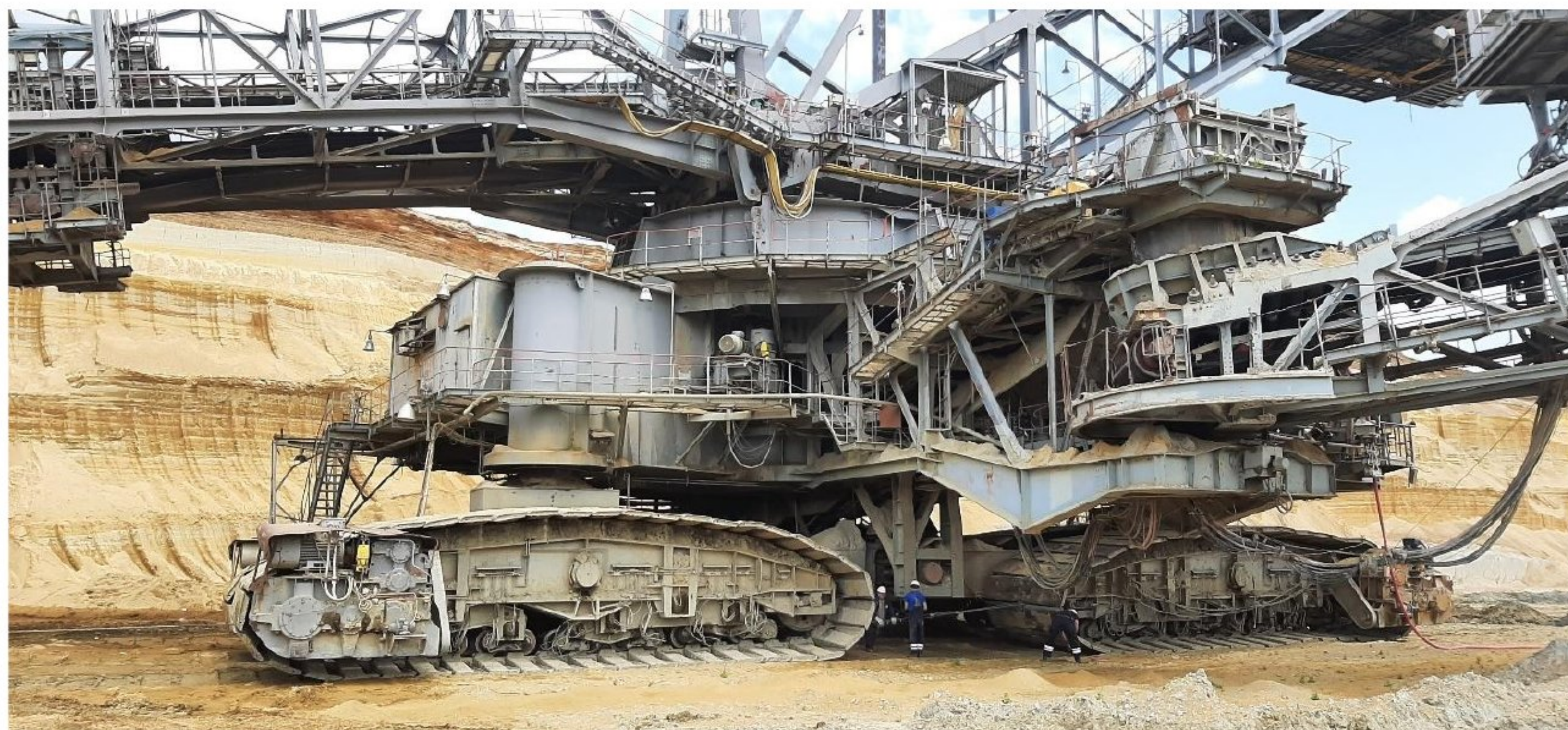
Slika 4. Obrtna platforma rotornog bagera
