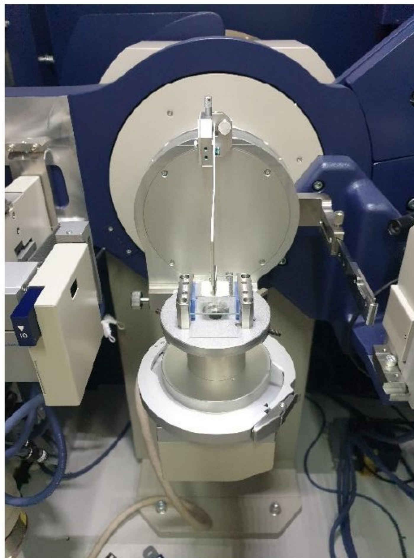
Slika 4.6: Uzorak na nosaču postavljen u Rigaku SmartLab difraktometru
