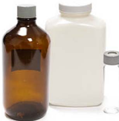
Slika 1.3. Boce za uzorke od različitih materijala
