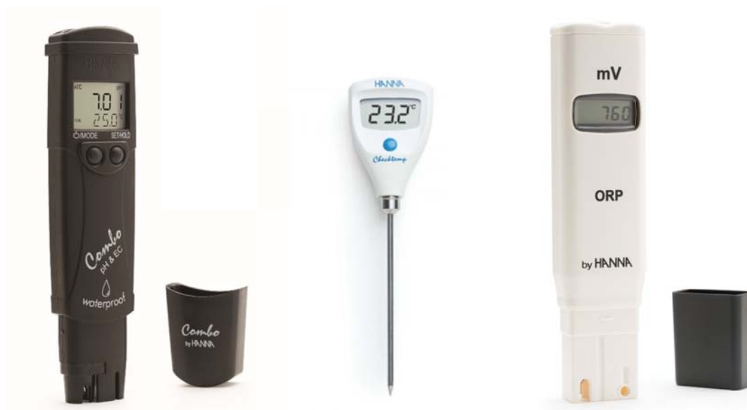
Slika 1.5. Terenski merni instrumenti (proizvođača Hanna ): levo – kombinovani pH/EC-metar; u sredini – digitalni termometar i desno – Eh-metar
