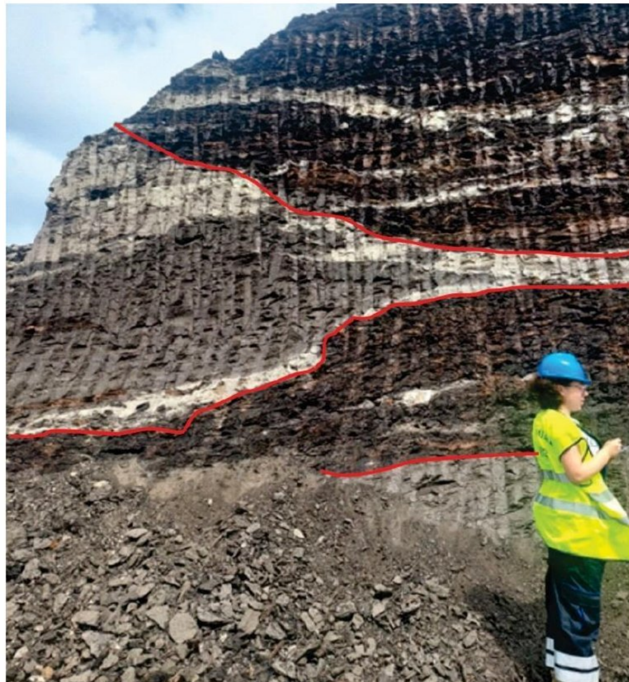
Slika 12 - postepeni prelaz slojeva ksilitnog uglja u ugljevite gline i peskove.
