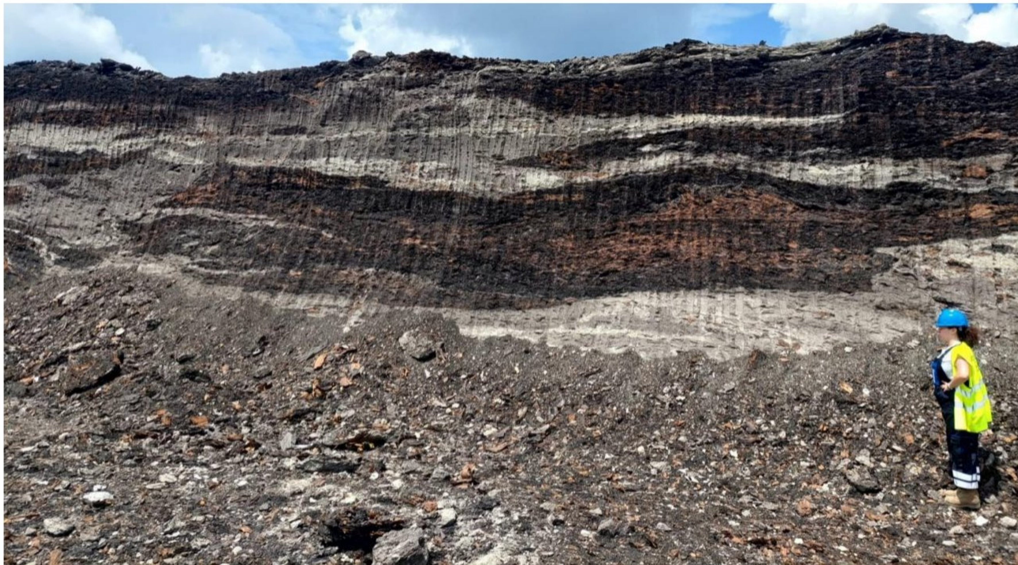
Slika 14 - Profil gornjeg dela III ugljenog sloja, na kom se jasno uočavaju brze lateralne promene litologije i slabo izražen kontinuitet debljine ugljenog sloja.
