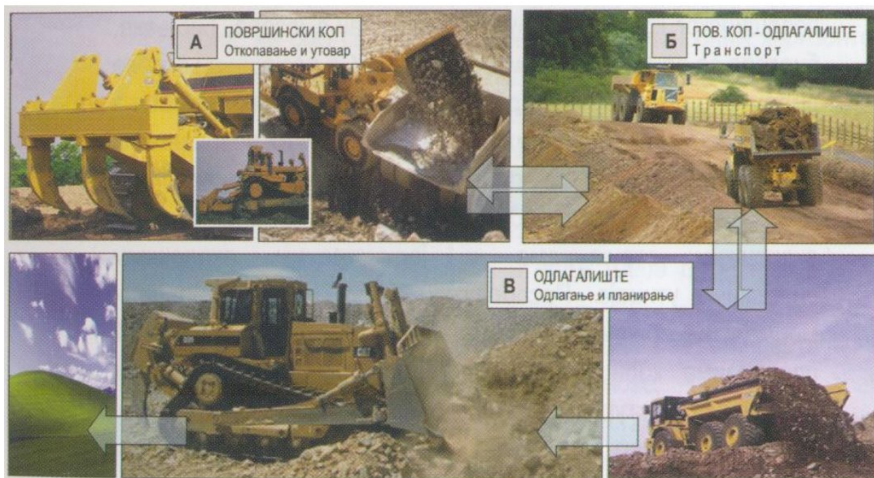
Слика 1. 19. - Технолошки ток селективног откопавања, транспорта и одлагања плодног земљишта машинама булдозер са рипером, утоварач, дампера, булдозер
