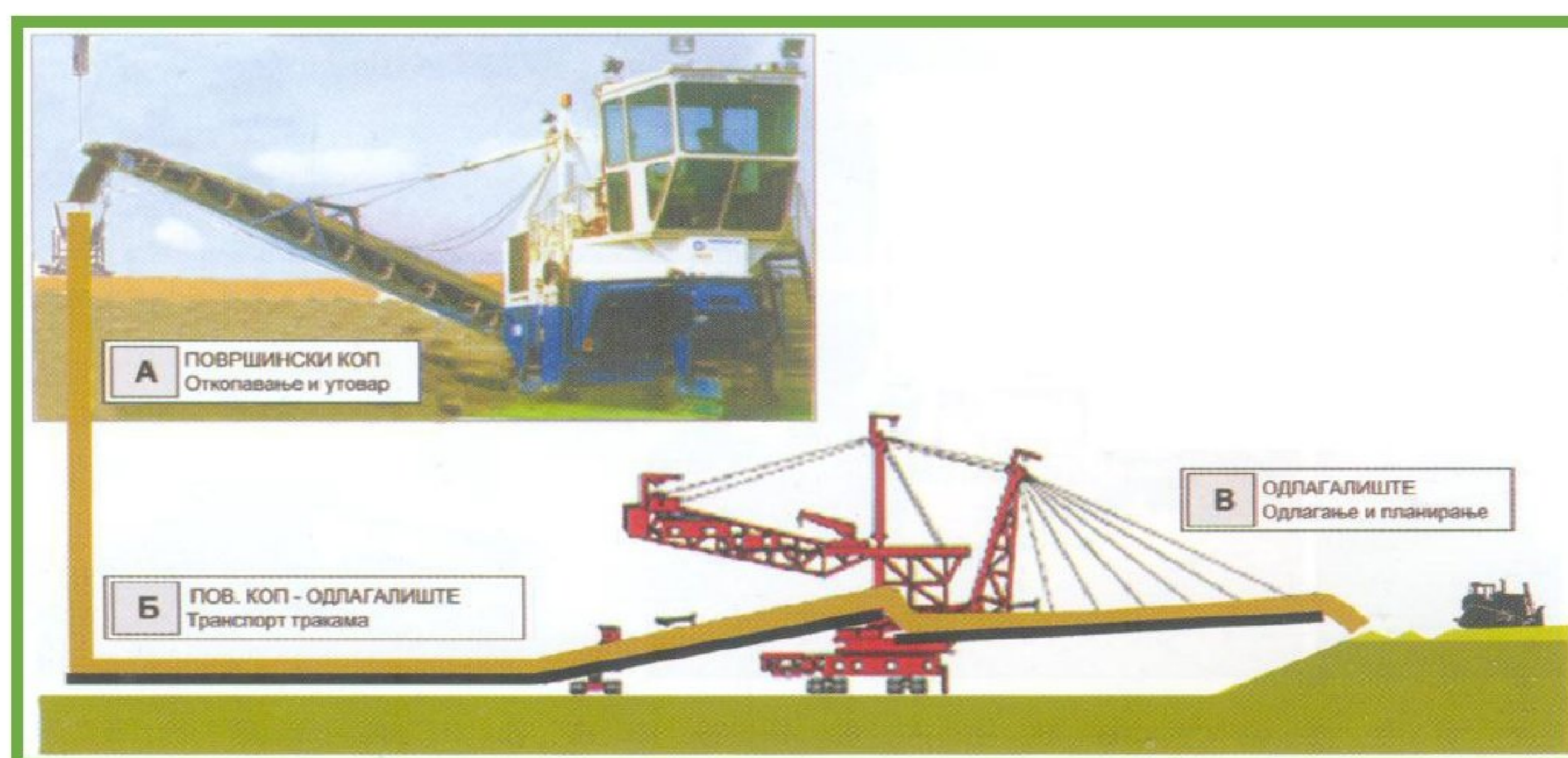
Слика 1. 18 - Технолошки ток селективног откопавања, транспорта и одлагања плодног земљишта машинама комбајн, траке, одлагача и булдозер
