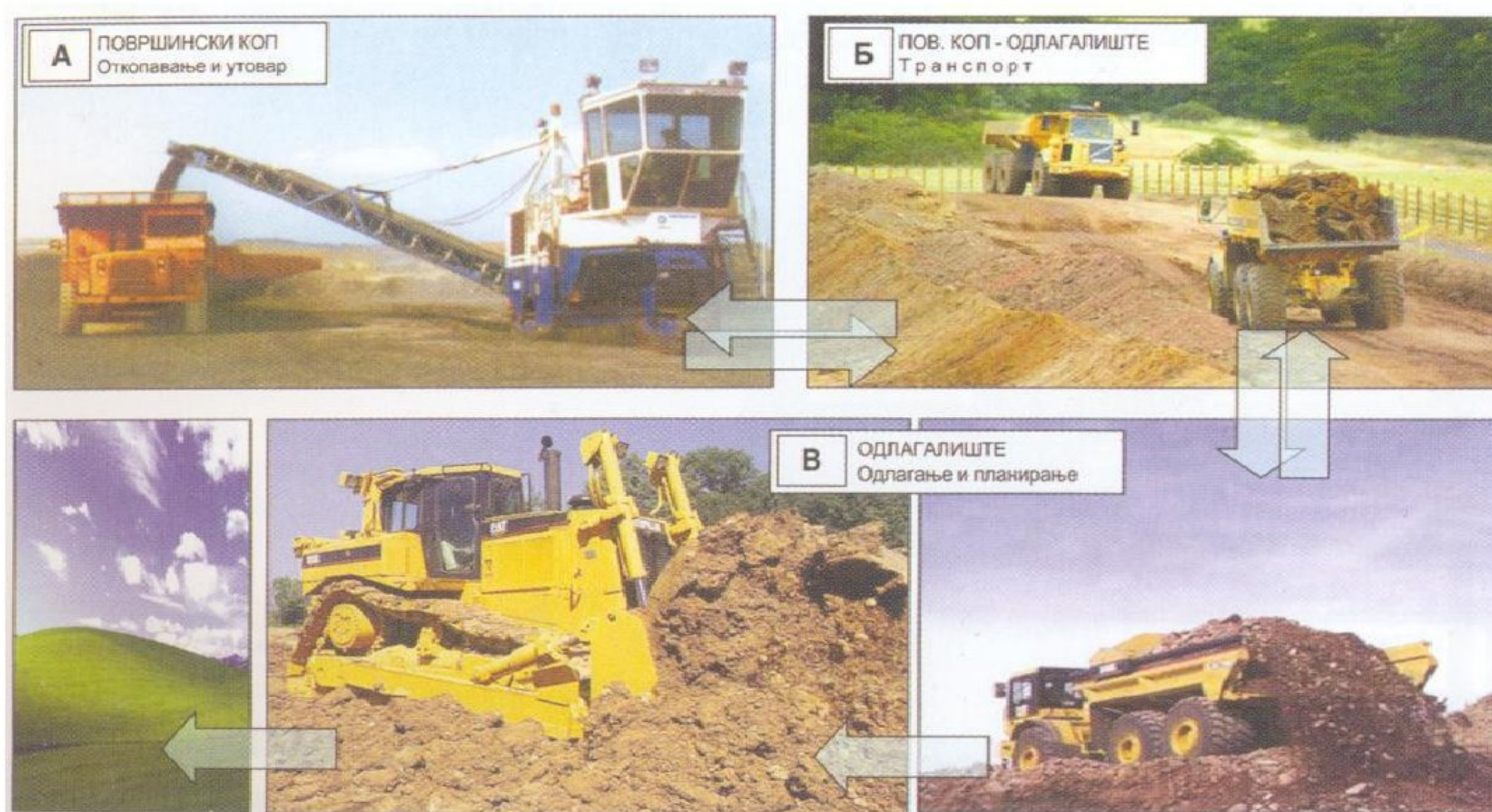
Слика 1. 17 - Технолошки ток селективног откопавања, транспорта и одлагања плодног земљишта машинама комбајн, дампера, булдозер
