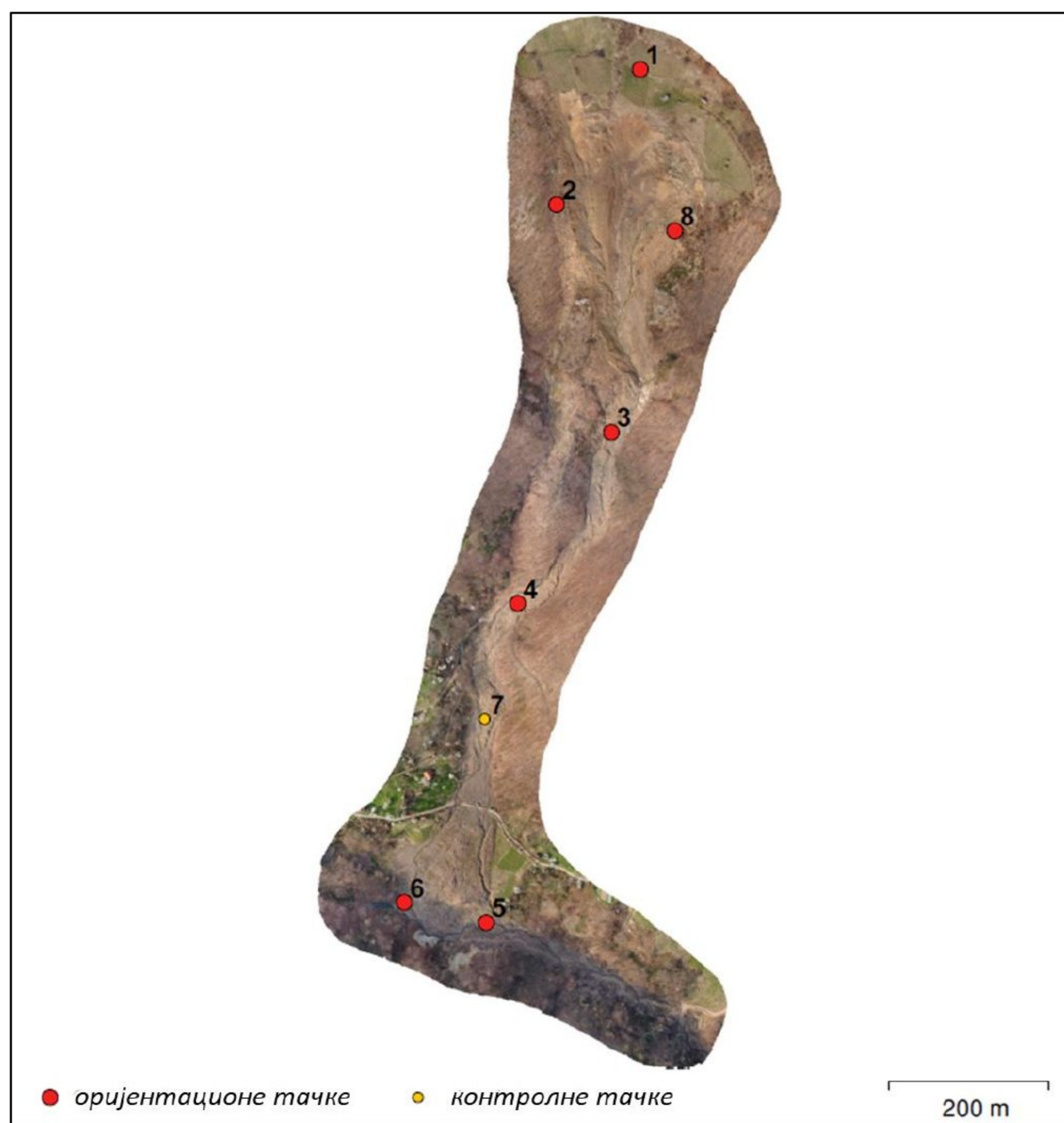
Слика 6.7 Положај оријентационих и контролних тачака
