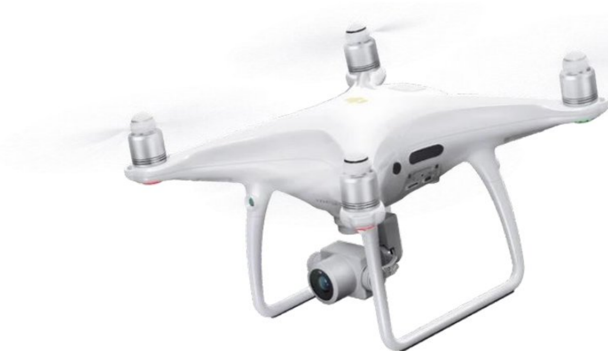
Слика 4.1 Модел беспилотне летилице DJI Phantom 4 pro коју је коришћен за снимање тецишта (преузето са https://www.dji.com/phantom-4-pro-v2?site=brandsite&from=eol_phantom-4-pro )
