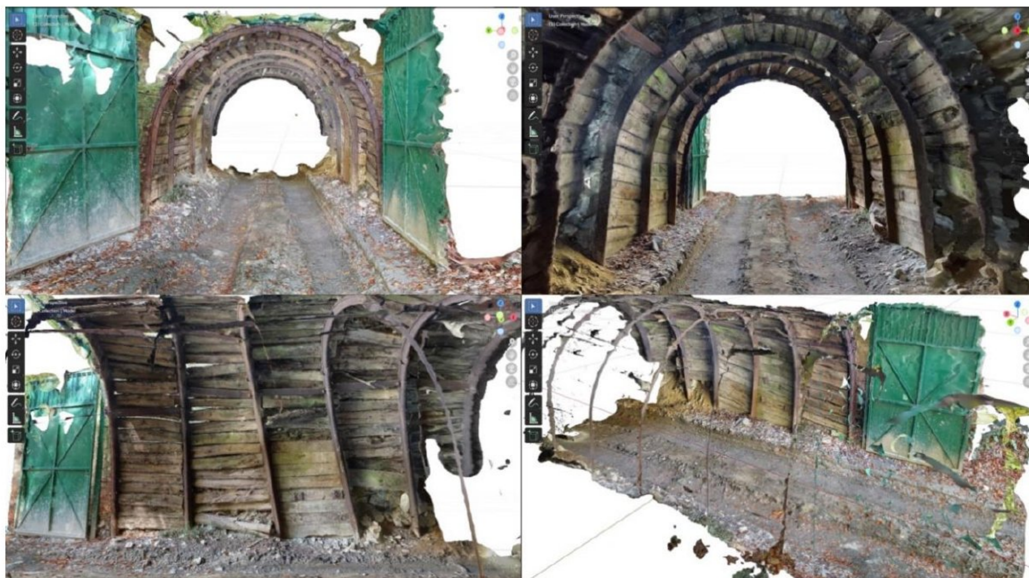
Slika 10. 3D model dela potkopa na horizontu „-50“
