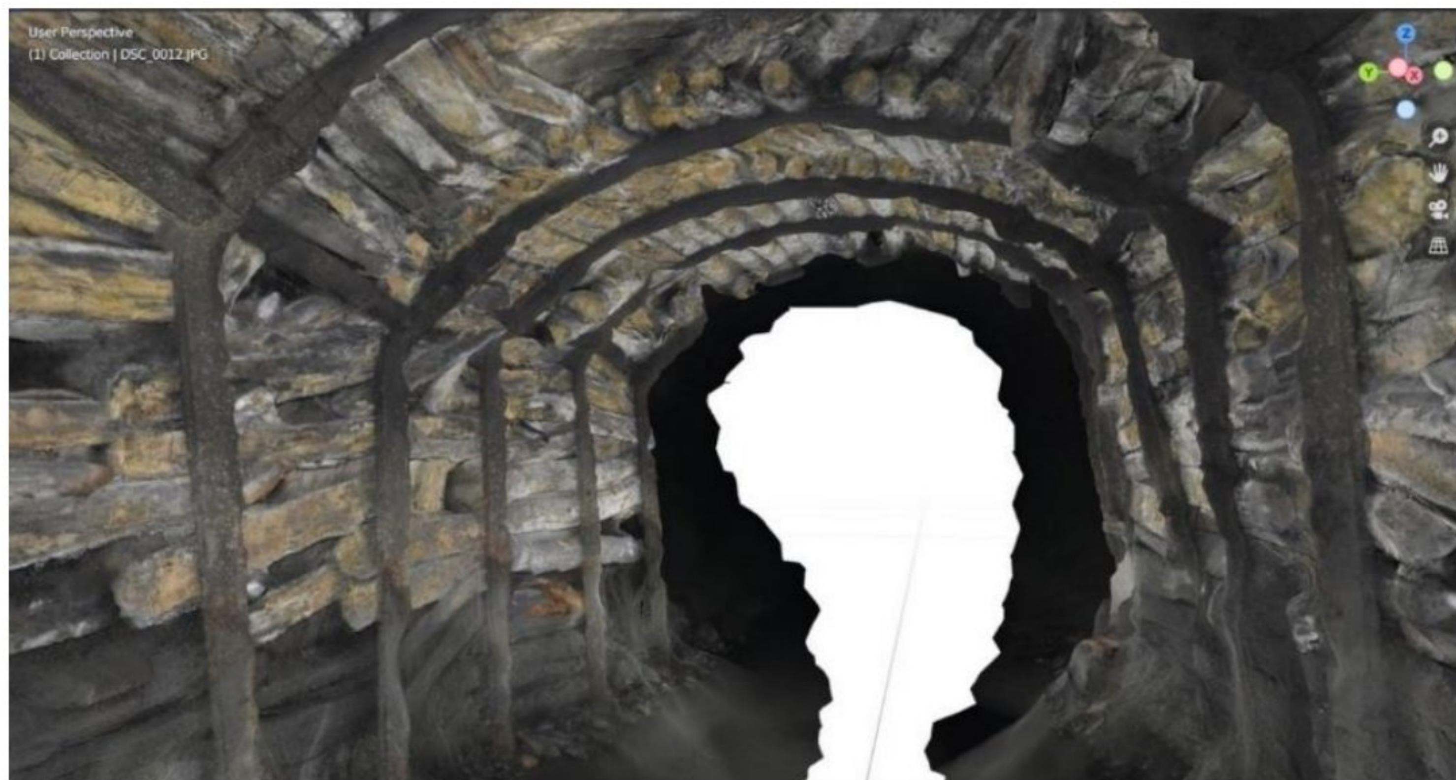
Slika 6. Prikaz fotografisanog i razvijenog modela dela hodnika IH R podgrađenog niskozasvođenom čeličnom podgradom.
