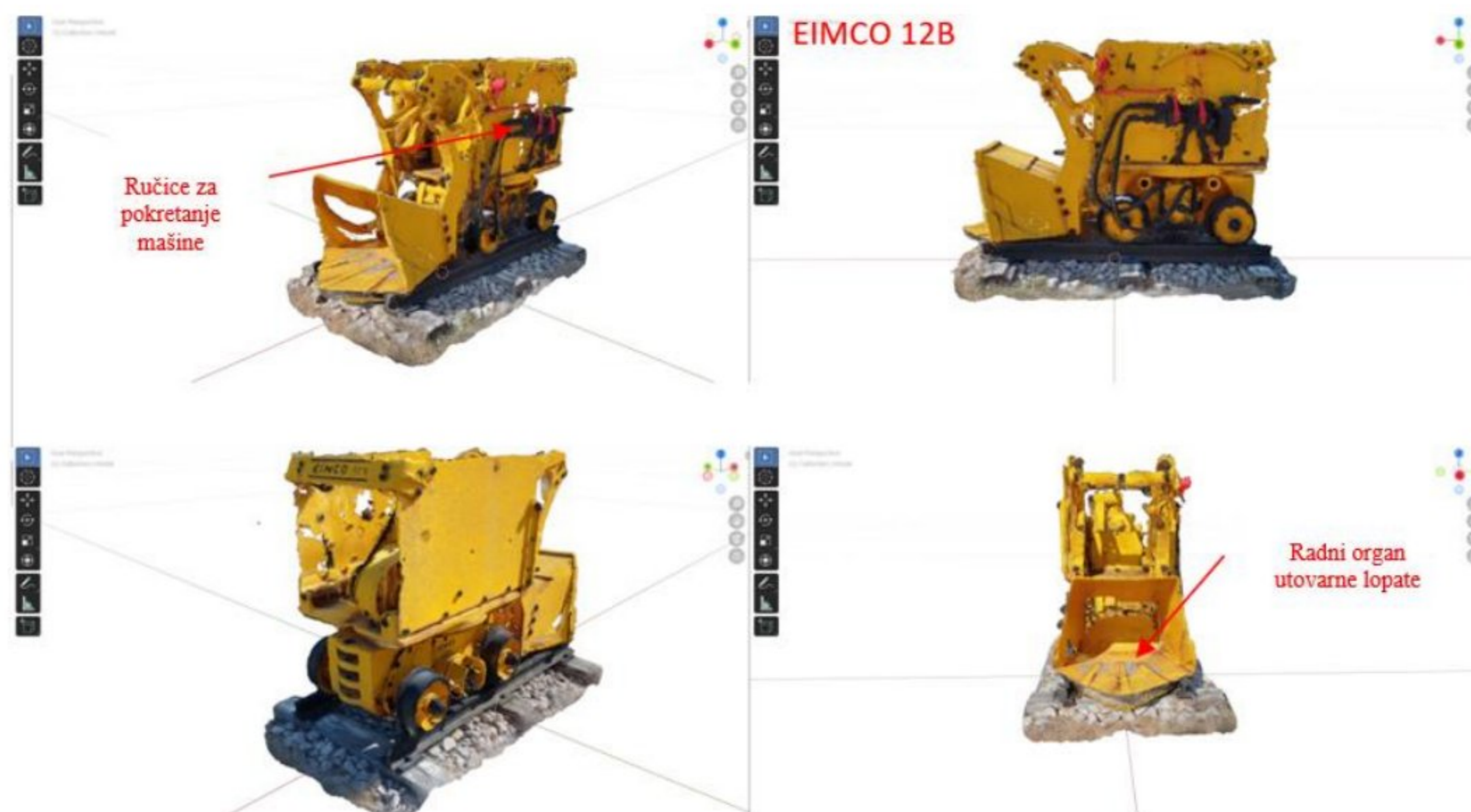
Slika 12. 3D model utovarača.
