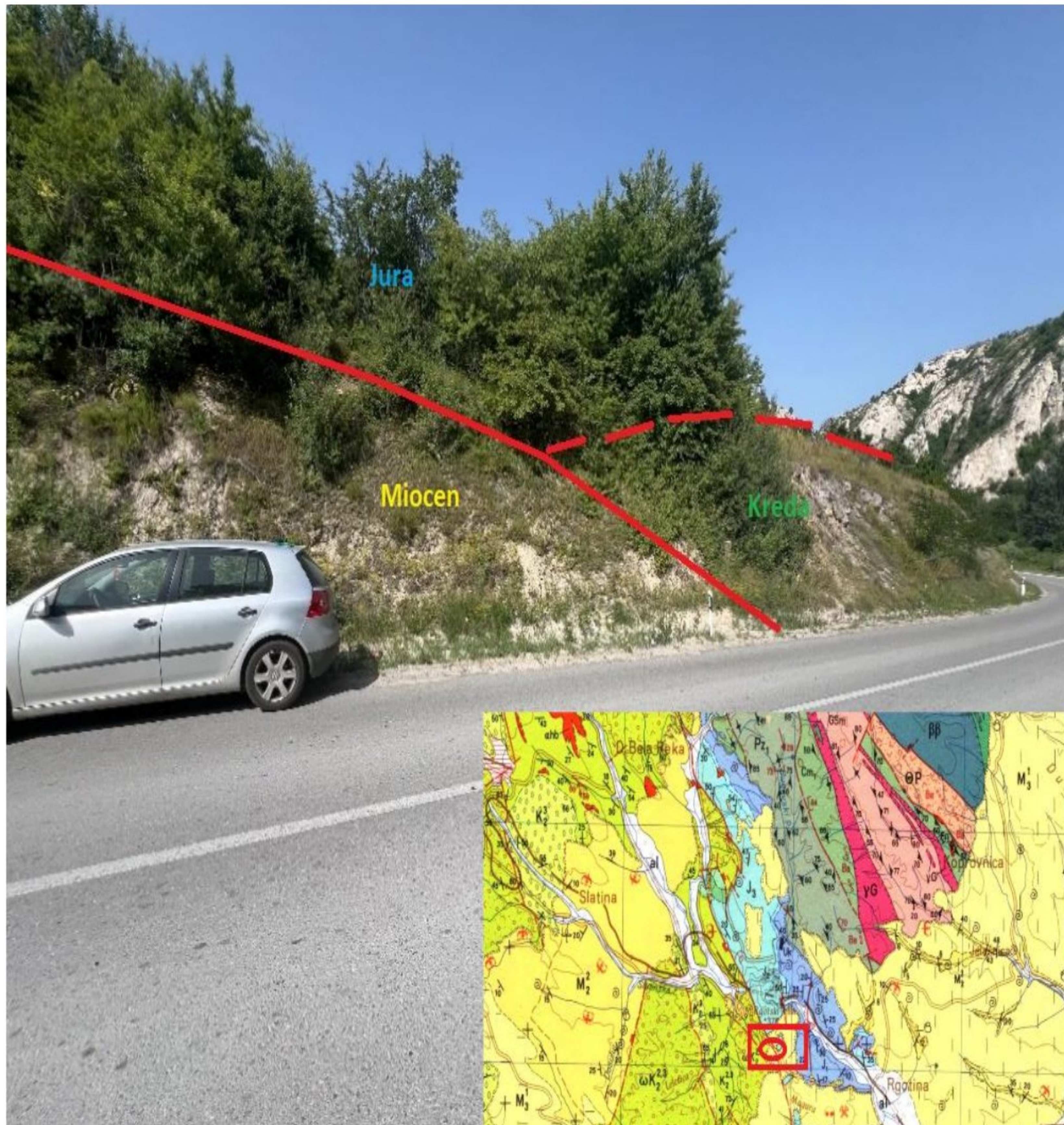
Slika 21. Kontakt miocenskih sedimenata sa krednim tvorevinama i jurskim tvorevinama
