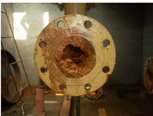
Слика 6.9: Потисни цевовод извучен из бунара Впз-1 Трновче (фото: Миолски 15.09.2010.)
