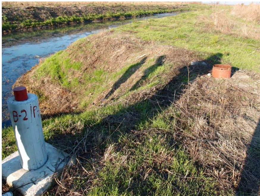
Слика 4.3.17: Блиски пијезометар избушен 2010. године уз дренажни бунар на подручју Ковин-Дубовац (фото: Мајкић 2012)
