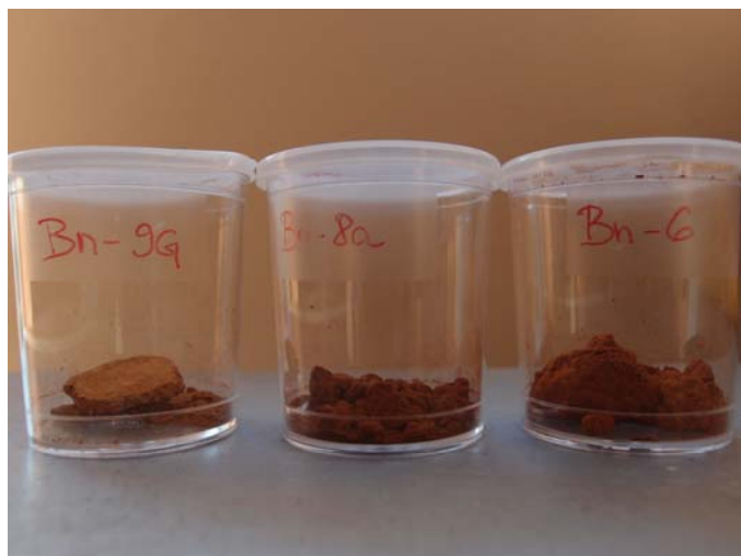
Слика 3.8: Осушени узорци талоба бунара Bn-9G, Bn-8a и Bn-6 са изворишта Трновче (фото: Мајкић 2011)
