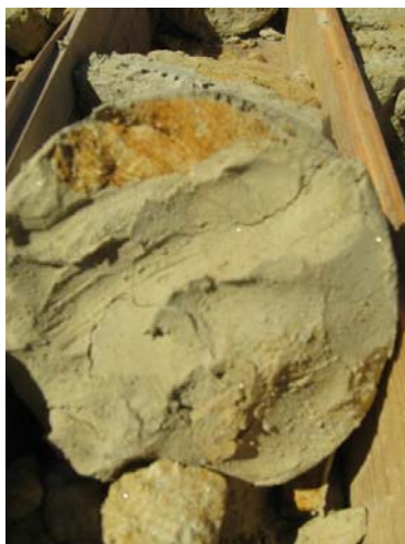
Слика 4.3.9: Узорак ситнозрно-алевритичних пескова из подине водоносног слоја (серије 5Р) набушеног испод корита Дунава у профилу Ковин на дубини од 8,5-9,8 m (фото: Мајкић 2012)
