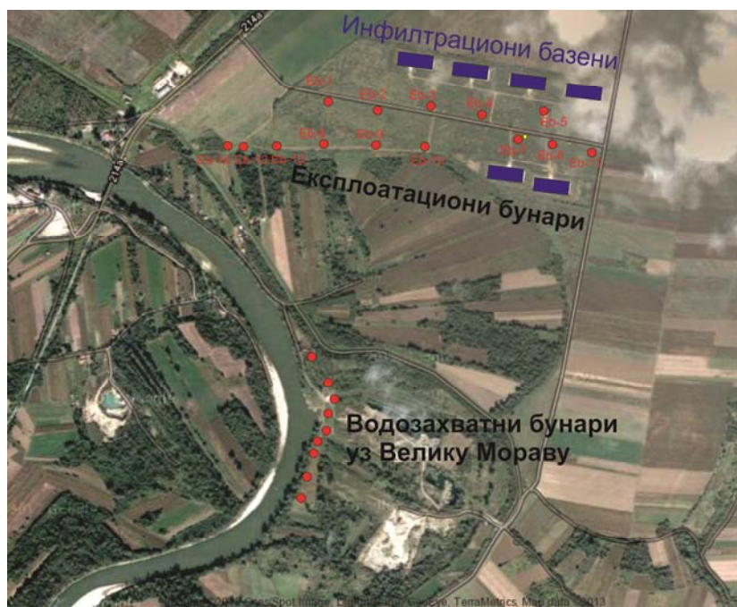
Слика 4.2.9: Диспозиција објекта изворишта Кључ – стање из јуна 2011. године (сателитски снимак преузет са www.googlemaps.com , додато Мајкић 2013)
