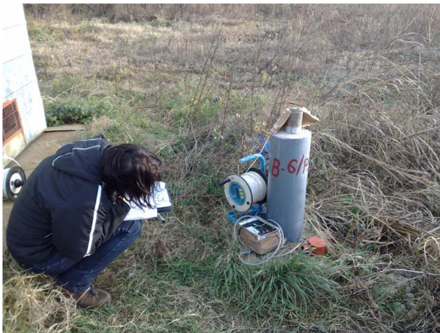
Слика 3.9: Блиски пијезометар Вп-6/Р-1 уз бунар Вп-6 на изворишту Трновче (фото: Мајкић 2011)
