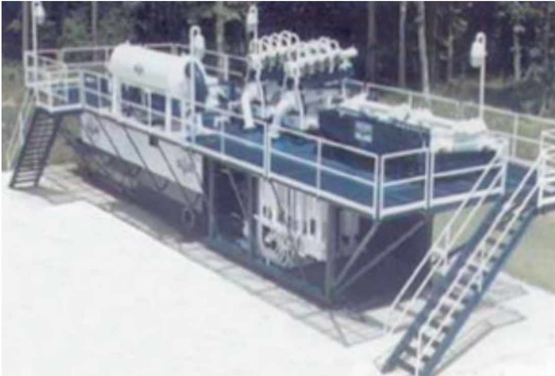
Slika 3.7.3 – Sistem za prečišćavanje isplake (izvor: Matanović D., 2007 „Tehnika izrade bušotine priručnik s primjerima“, Zagreb)
