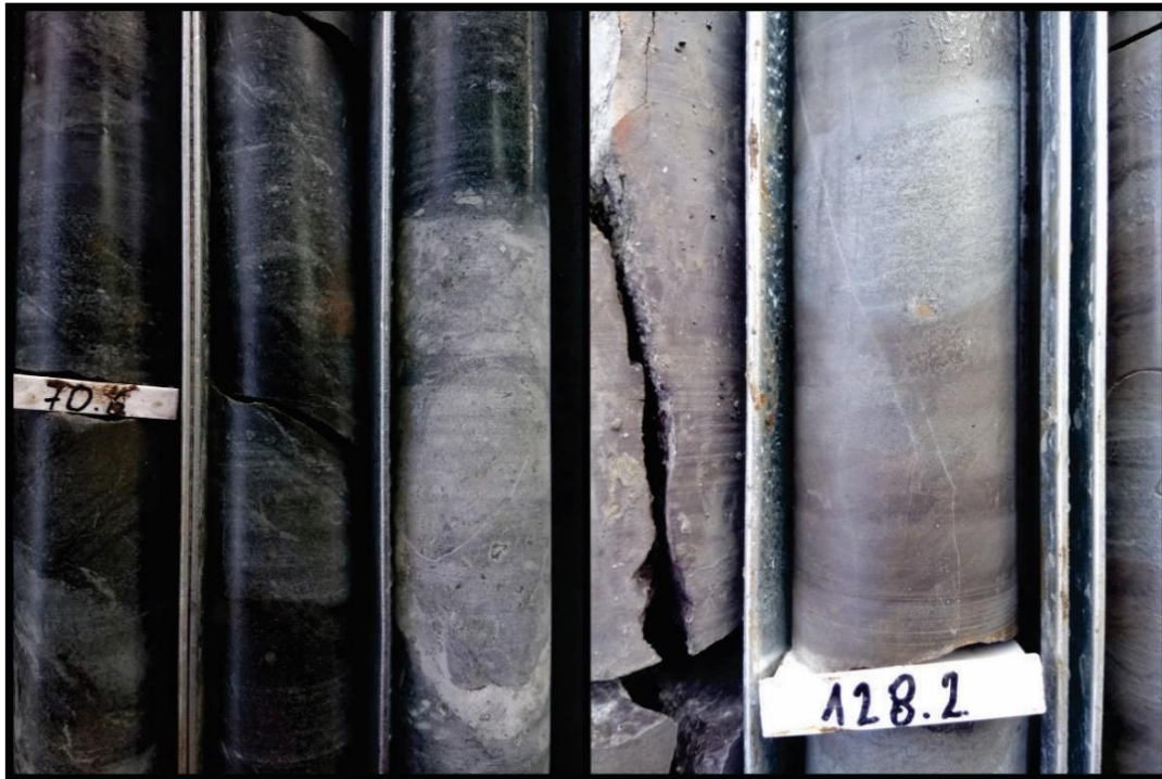
Slika 13: Smena peščara i laporaca u bušotini 294/18.
