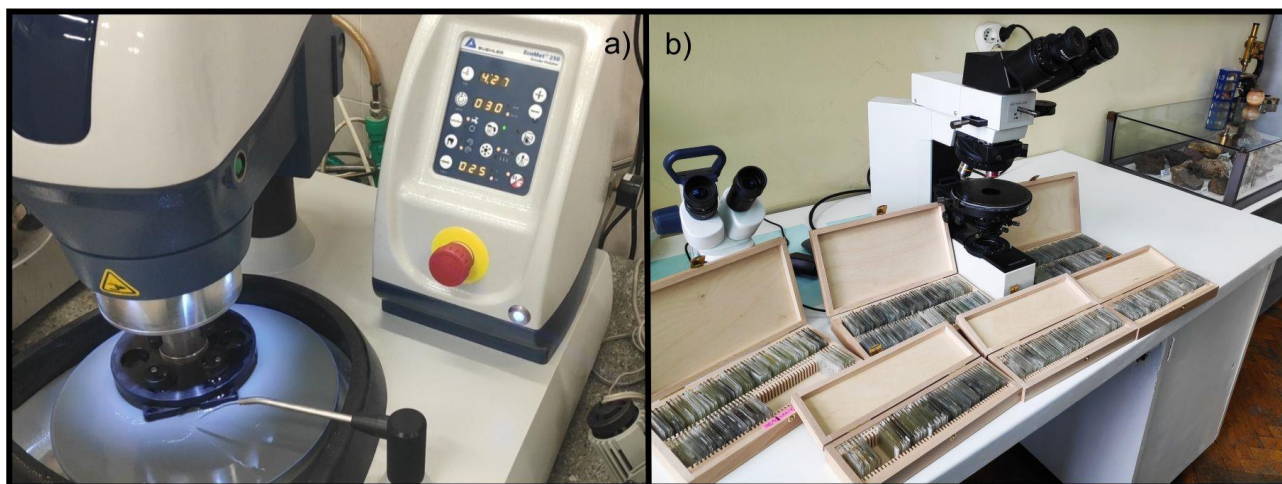
Slika 6: Mašina za poliranje i pripremu petrografskih uzoraka (a), Polarizacioni mikroskop za propuštenu svetlost (b).
