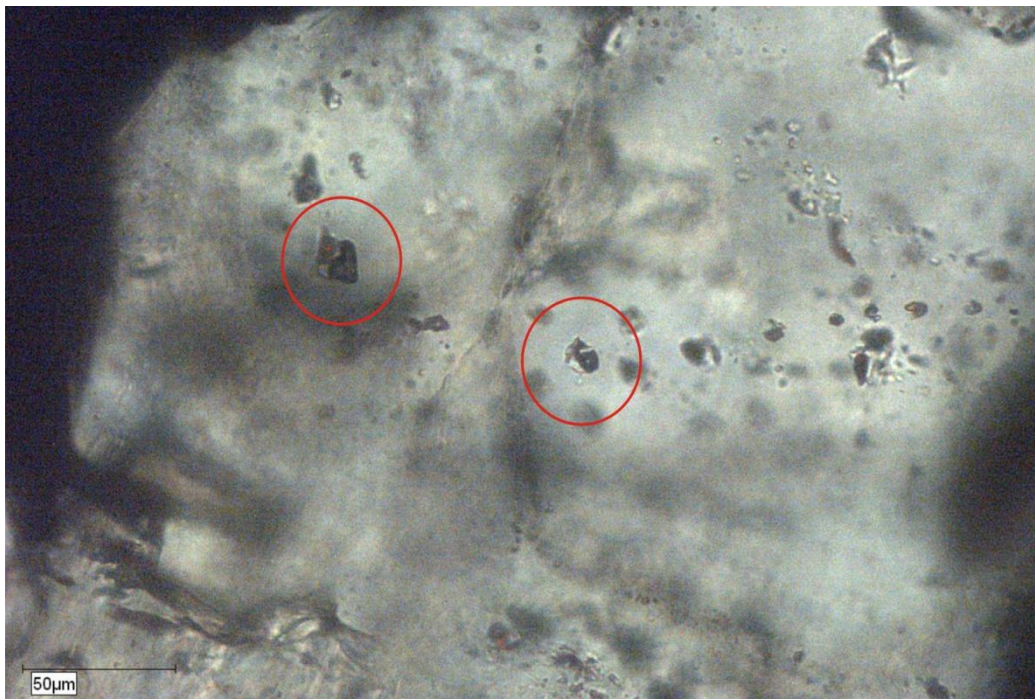
Слика 106-2: Групација ситних инклузија са кристалом хематита и кристалима соли (вероватно тип 2а), пропуштена светлост.
