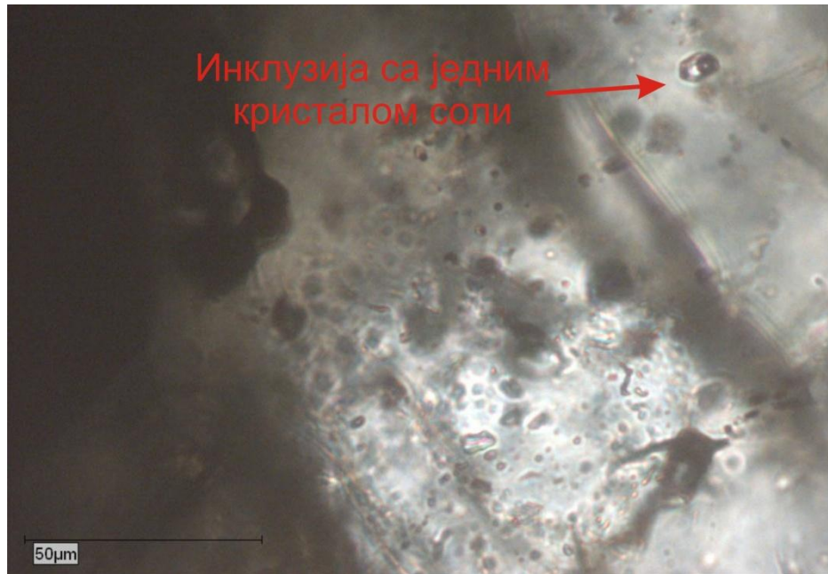
Слика 96-2: Инклузије са једним кристалом соли и непровидним сулфидом (тип 3) у кварцу, пропуштена светлост. Означена инклузија је хомогенизовала на температури од 375°C.
