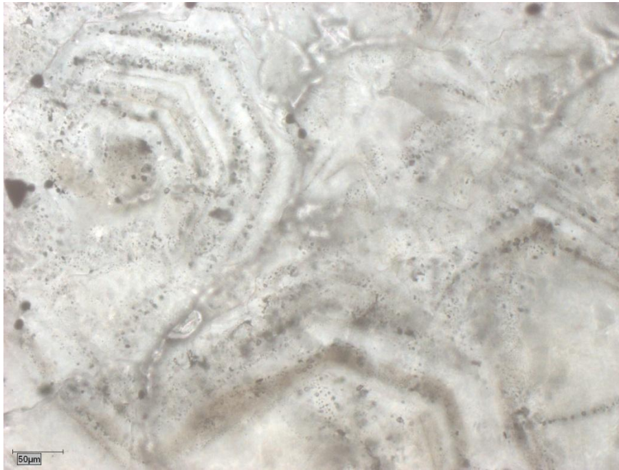
Слика 86-4: Примарне флуидне инклузије (тип 1) у зонама раста кварца, пропуштена светлост.
