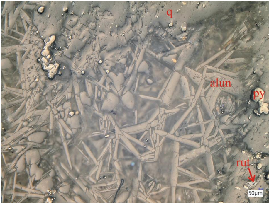
Слика ср126-2: Кристали алуниита (alun), вероватно на месту излуженог зрна плагиокласа, док су пирит (py) и рутил (rut) у кварцу око овог зрна, одбијена светлост.
