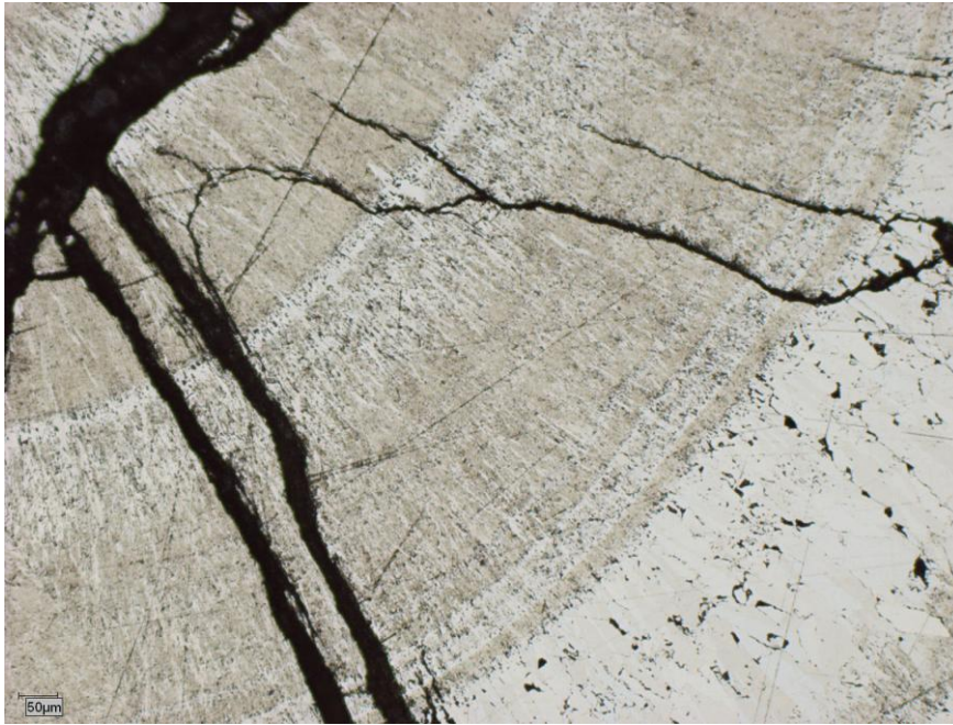
Слика 41-5: Зонарни раст колоформног маркасита, одбијена светлост.
