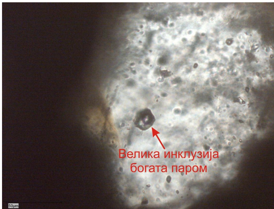
Слика 96-3: Велика инклузија богата паром (тип 4) у кварцу, пропуштена светлост.
