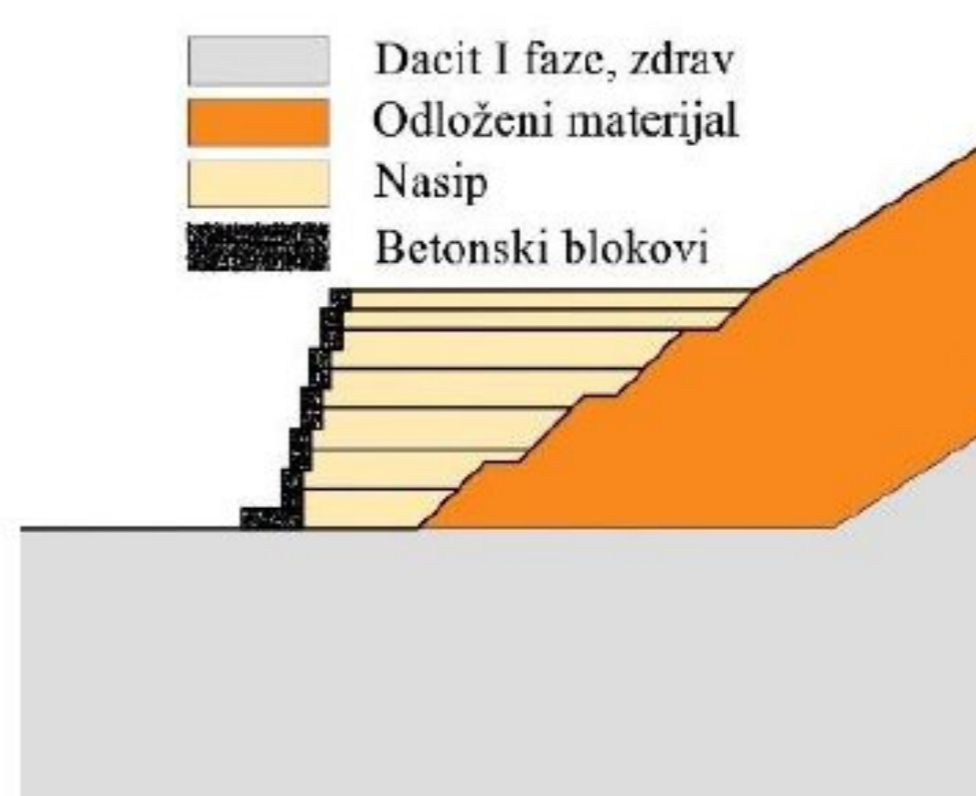
Slika 8. Izgled nasipa sa formiranim potpornim zidom od a) gabionskih elemenata i b) prefabrikovanih betonskih blokova
