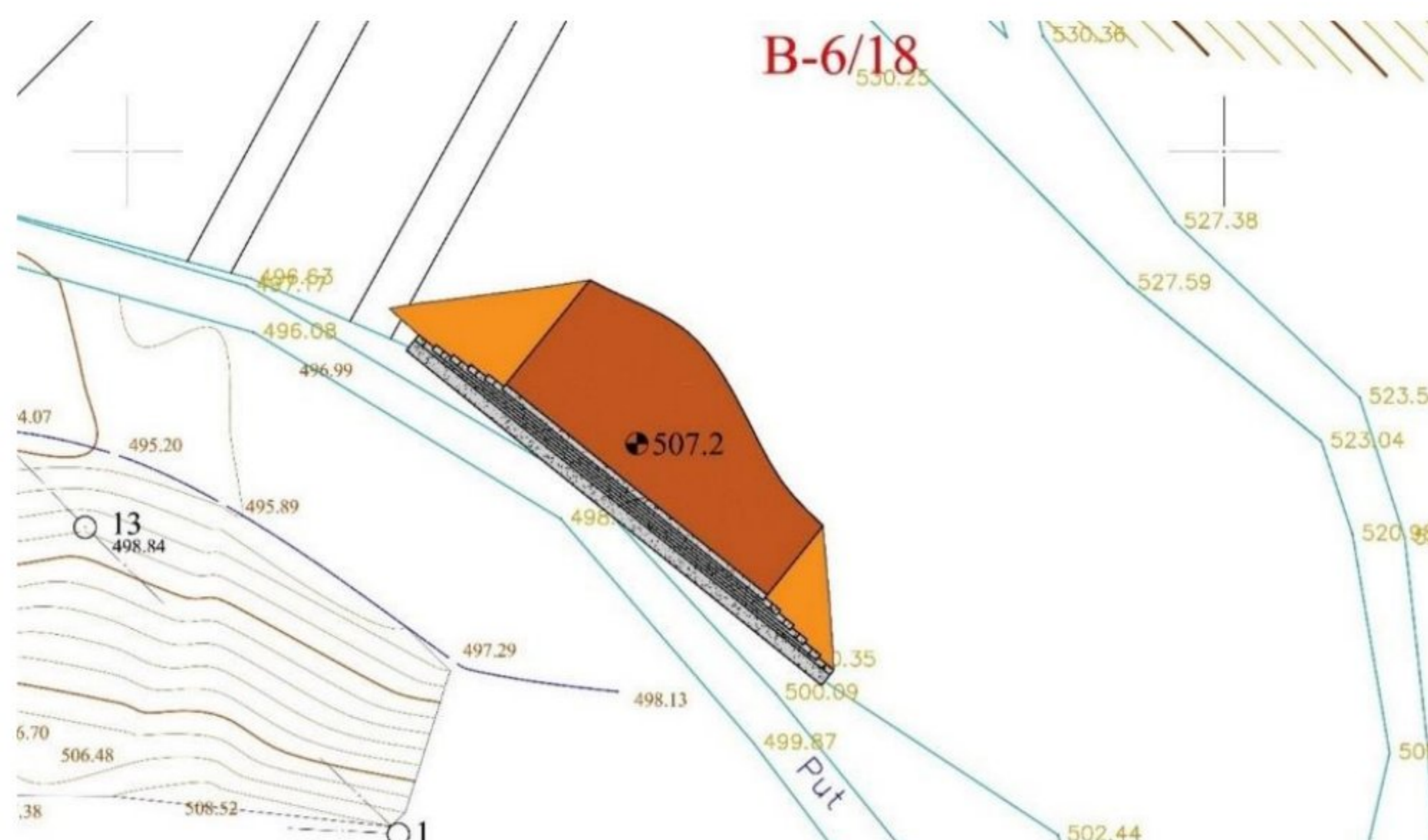
Slika 22. Izgled zone kosine pristupnog puta u jugoistočnom delu PK Ćeramide nakon formiranja nasipa i potpornog zida od prefabrikovanih betonskih elemenata (blokova)
