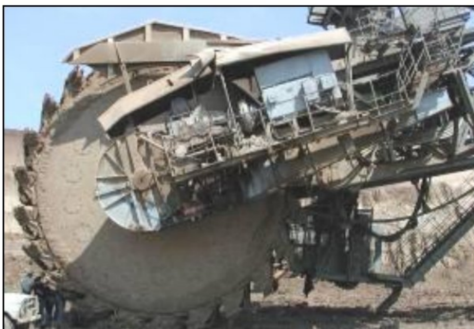
Slika 11. Pogon radnog točka rotornog bagera SRs1300.26/5 pre i posle rekonstrukcije
