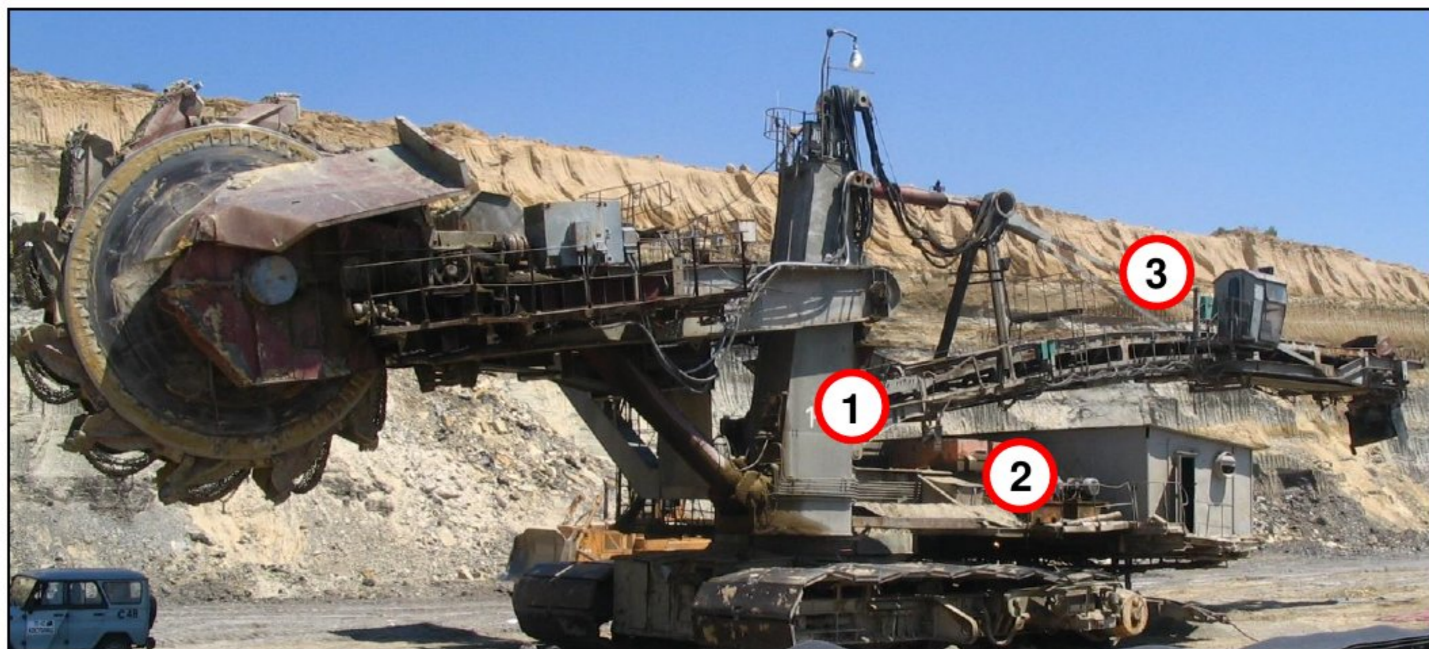
Slika 3. Lokacije mernih mesta: merno mesto 1 – unutrašnja strana centralnog stuba gornje gradnje (kutijasti nosač); merno mesto 2 – glavni nosač protivtega (I profil); merno mesto 3 – lamela istovarne strele (lim)
