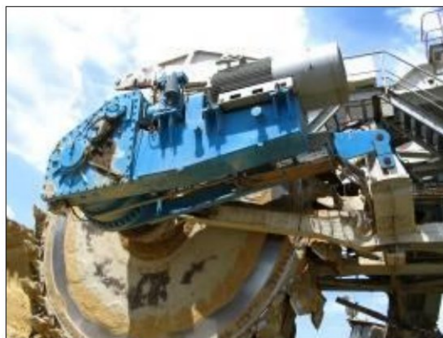
Slika 11. Pogon radnog točka rotornog bagera SRs1300.26/5 pre i posle rekonstrukcije
