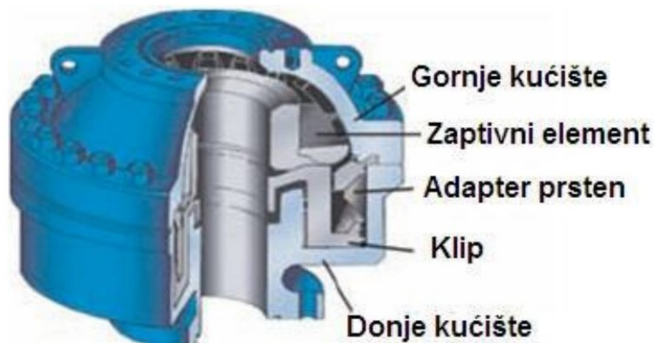
Slika 8 – Sferični preventeri Shaffer (Korov, 2011.)
