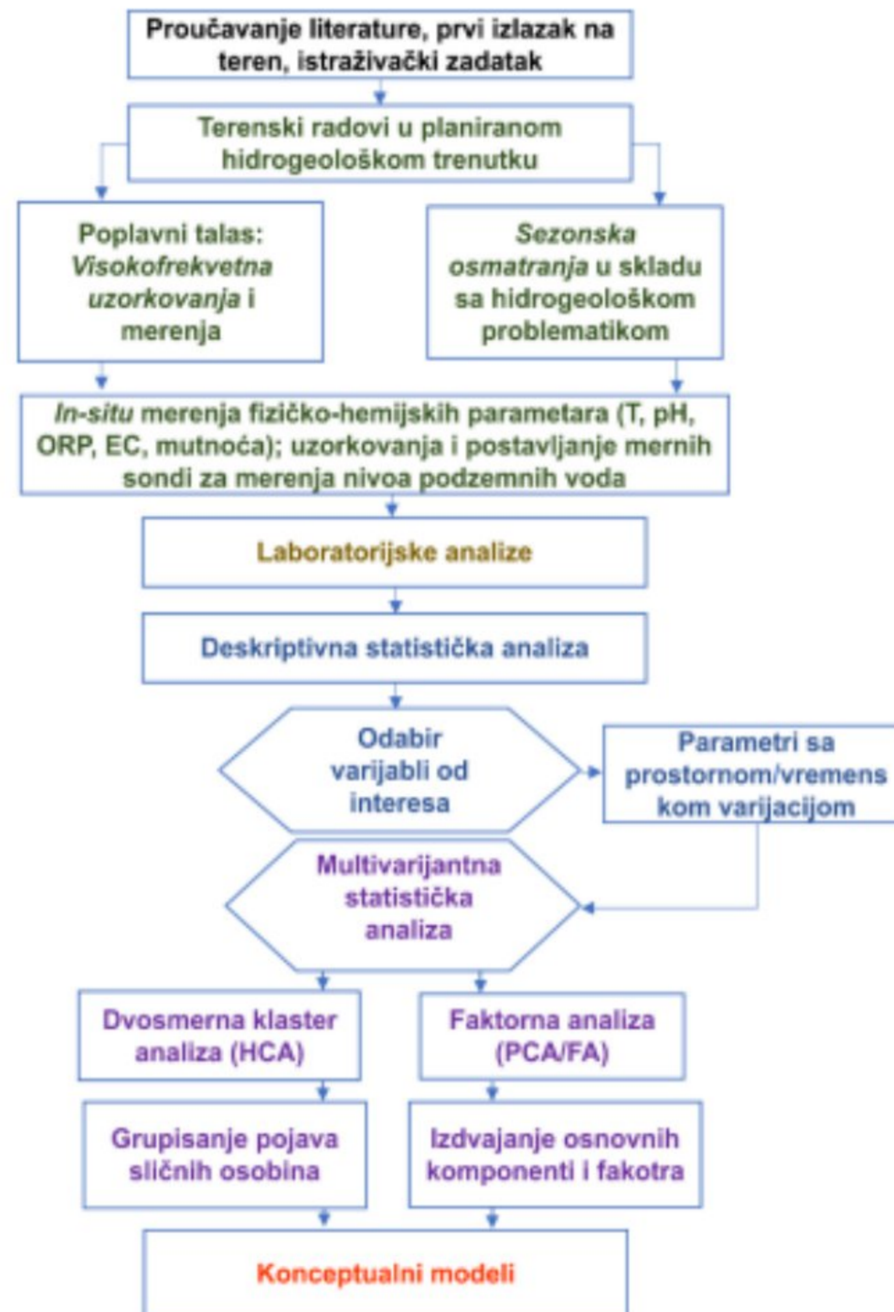
Slika 1. Dijagram toka implementiranih metoda i postupaka koji su rezultirali formiranjem konceptualnog modela.
