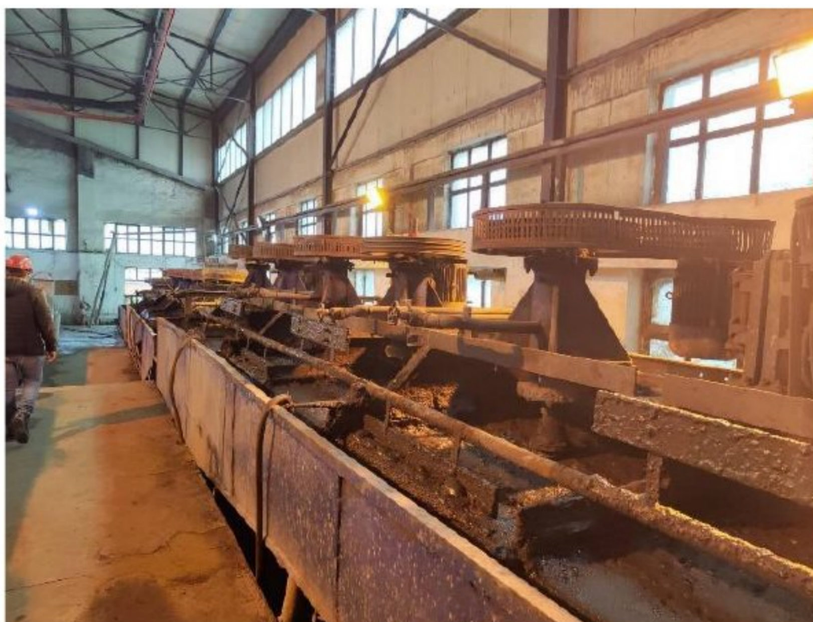
Слика 20 Машине основног флотирања пирита
