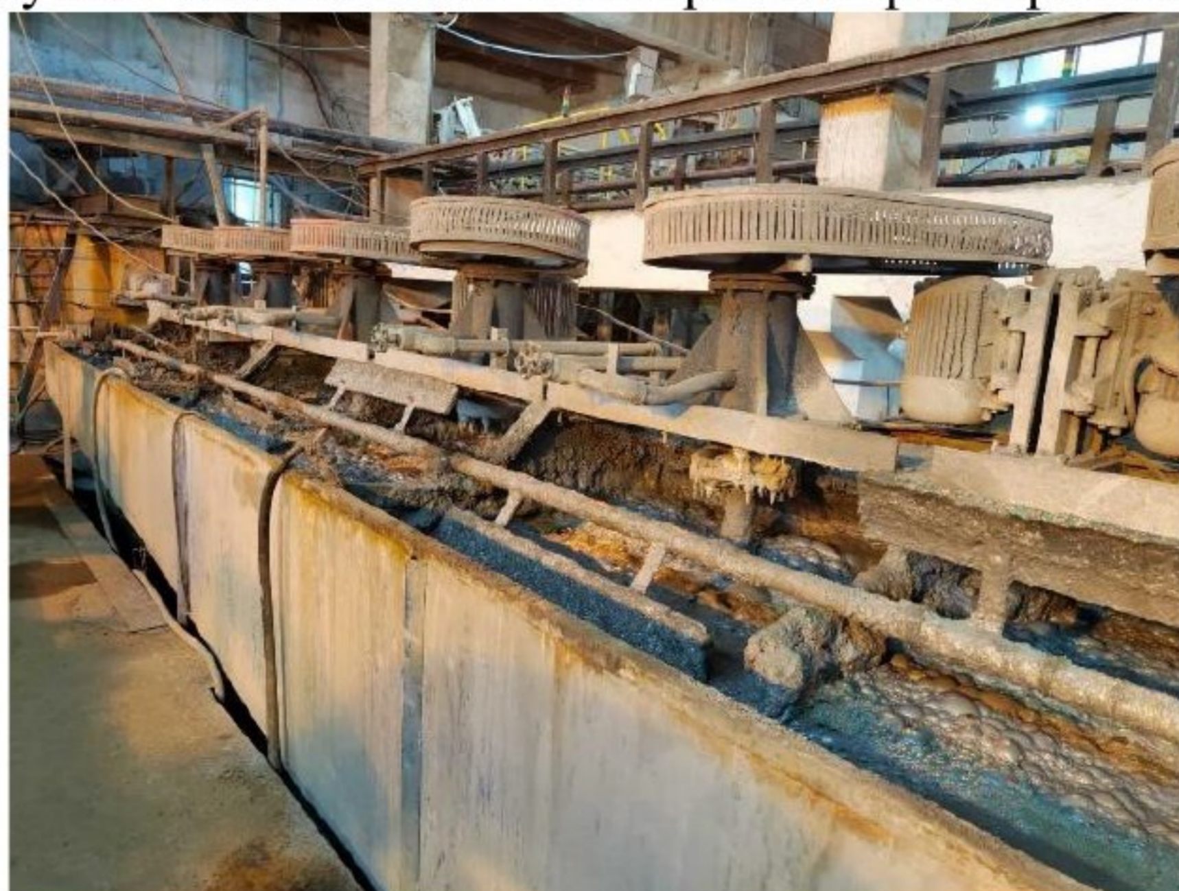
Слика 15 Машине за флотирање цинка
