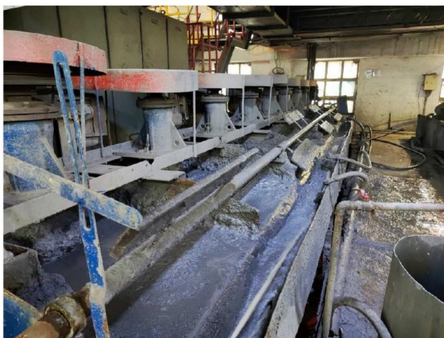
Слика 16 Машине за пречишћавање концентрата цинка
