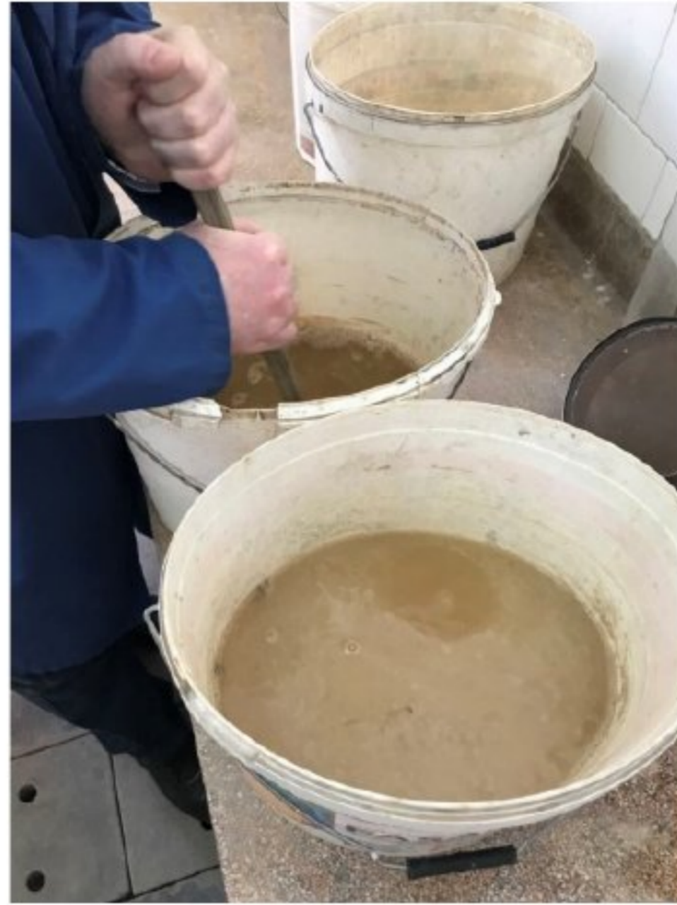
Слика 36 Припрема материјала за мокро просејавање
