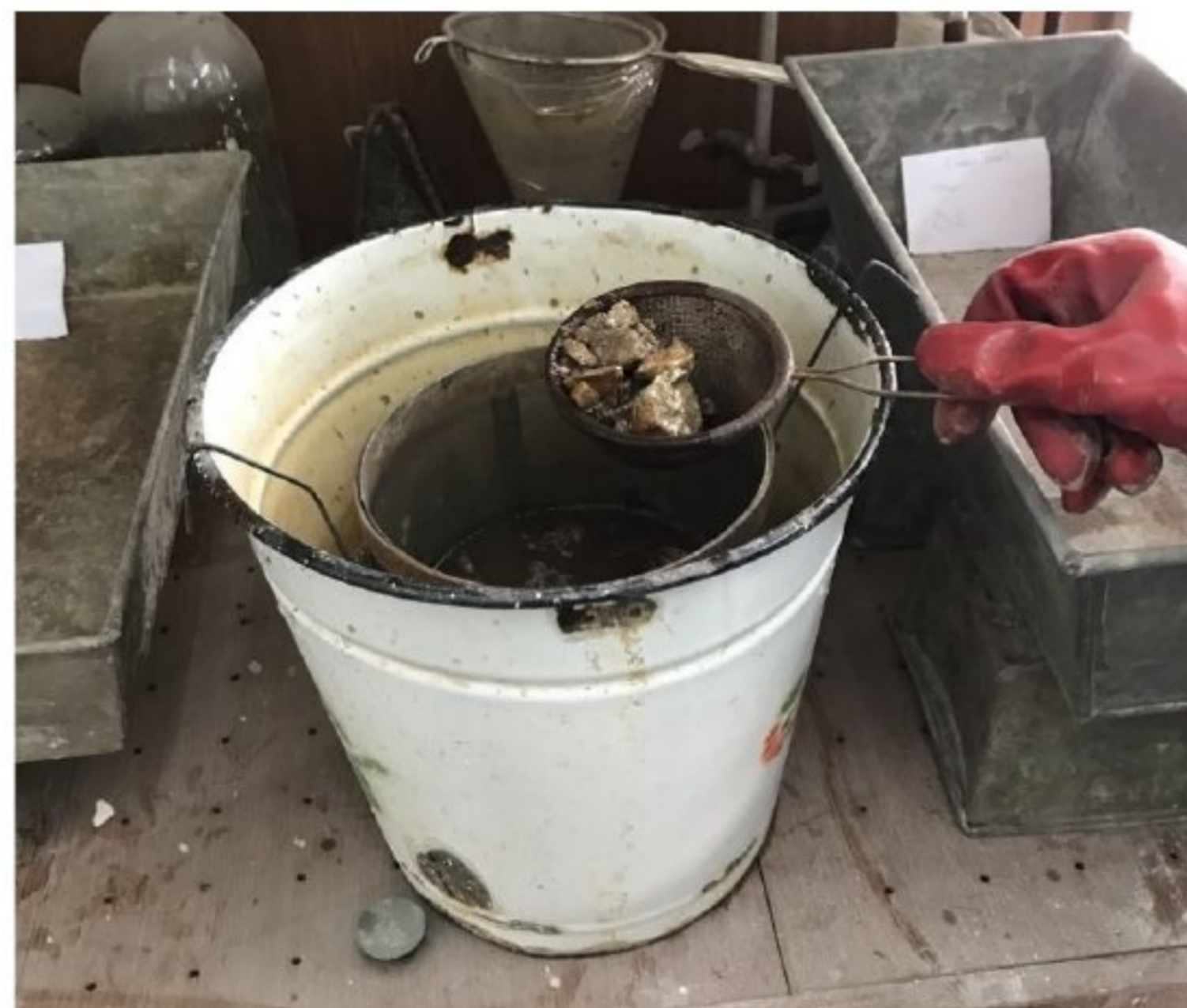
Слика 44 Изузимање лаке фракције перфорираном кашиком
