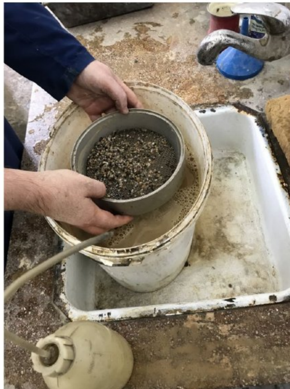
Слика 37 Мокро просејавање на ситиу отвора 2,5 mm
