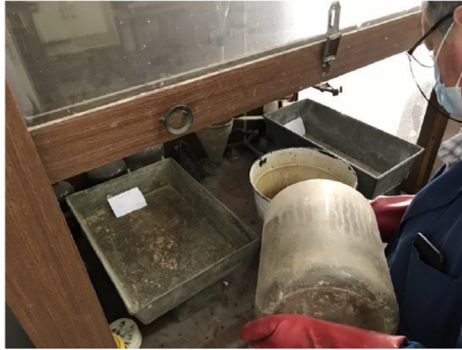
Слика 42 Додавање тешке течности (бромоформа) у канту
