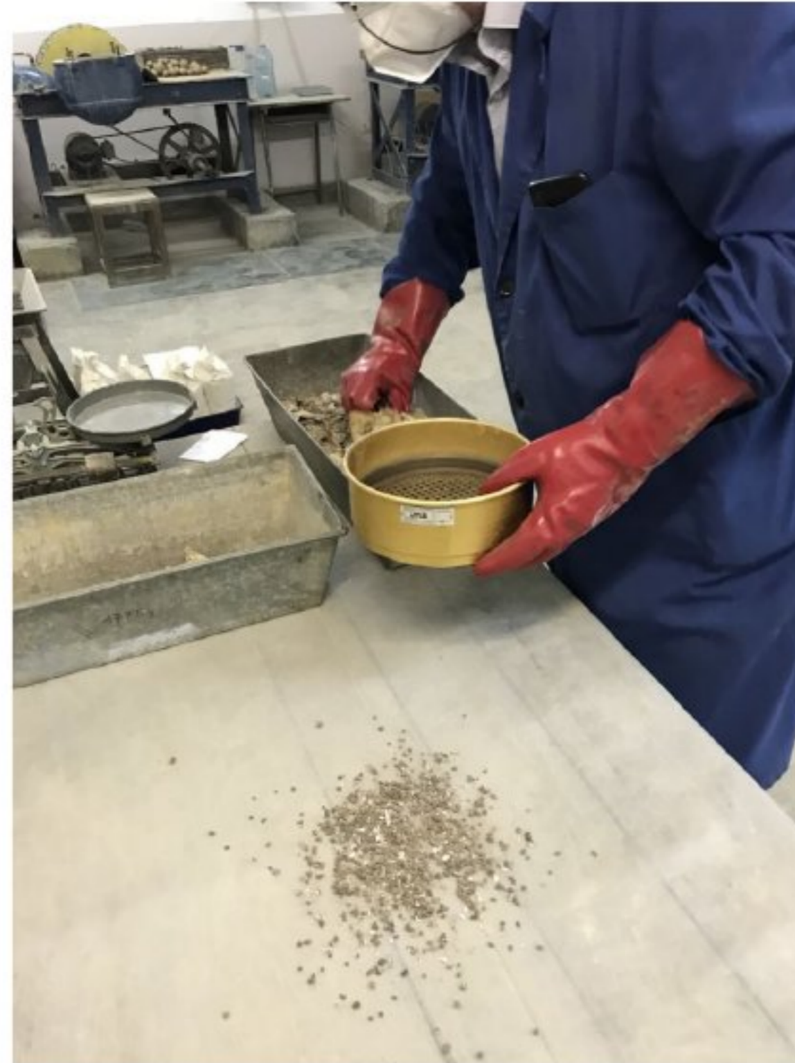
Слика 49 Просејавање пре дробљења у дробилици са глатким ваљцима
