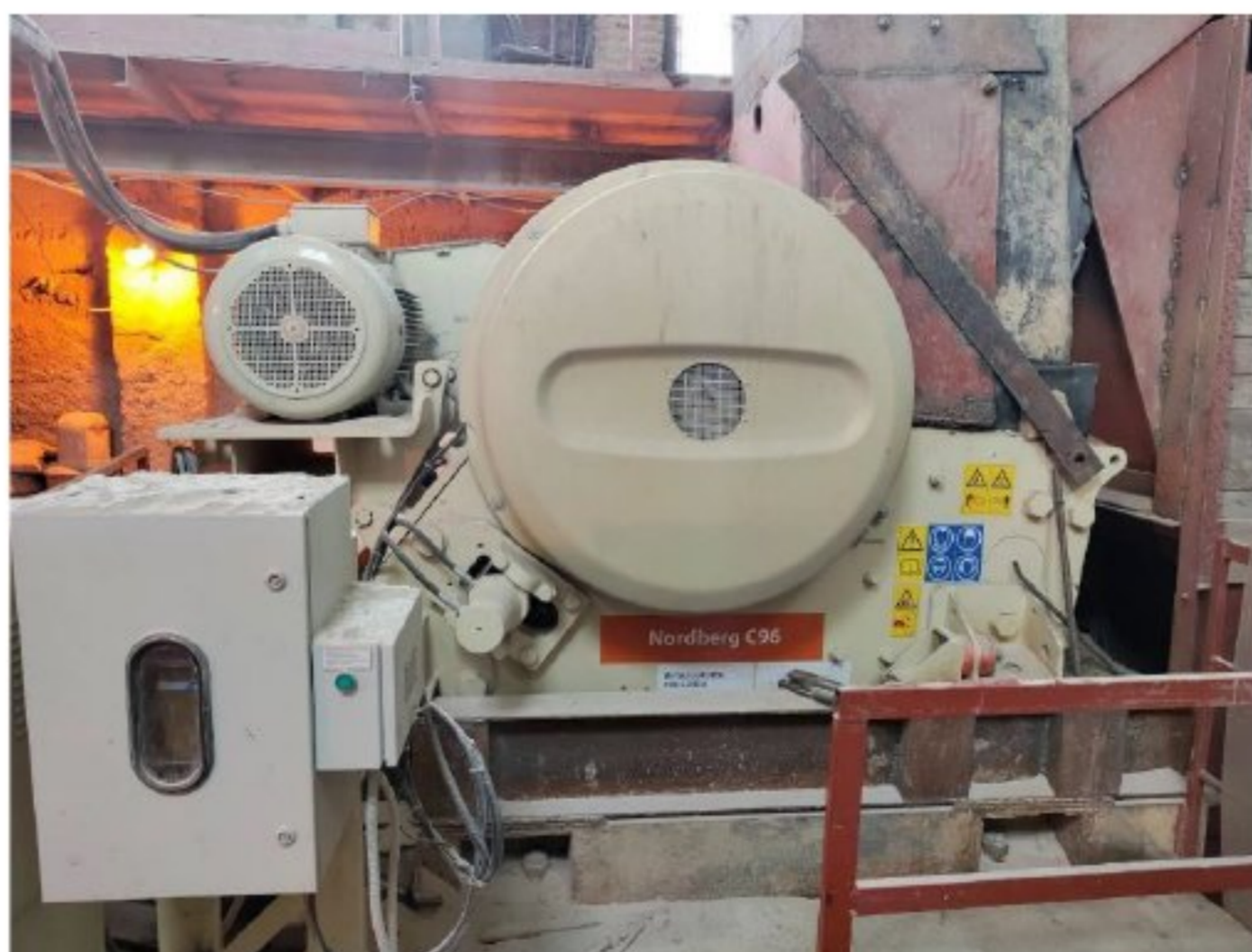
Слика 3 Чељусна дробилица „METSO C96“
