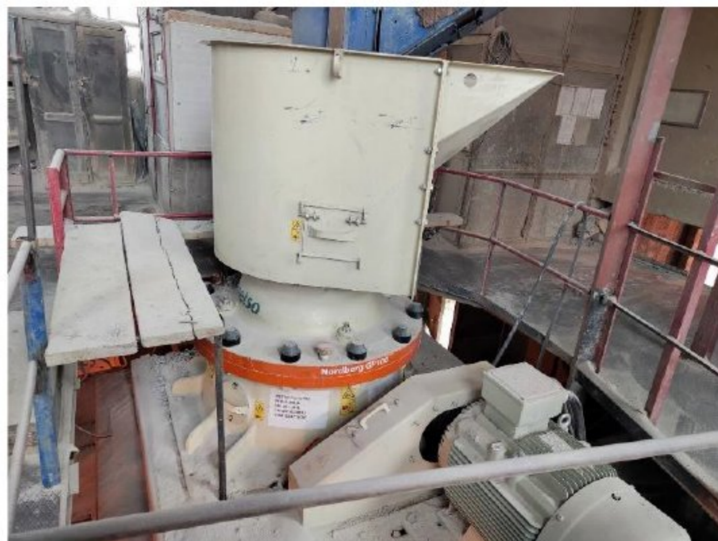
Слика 4 Конусна дробилица „METSO GP100“
