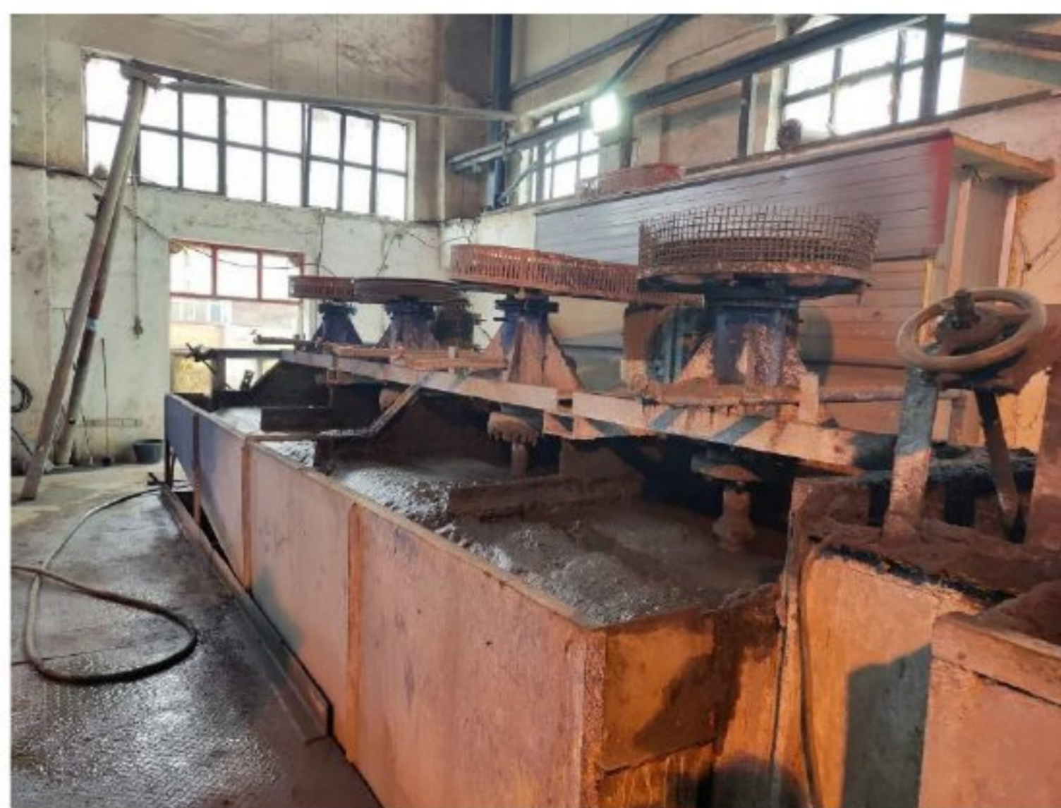
Слика 21 Машине контролног флотирања пирита
