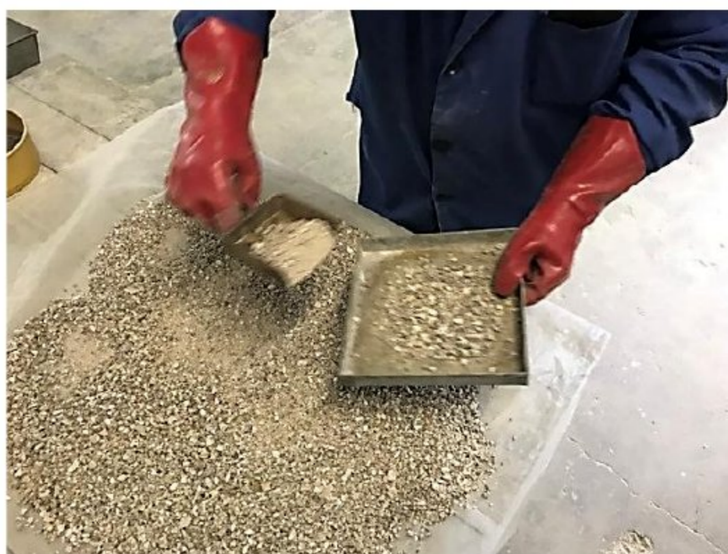
Слика 53 Узимање узорка методом шах поља
