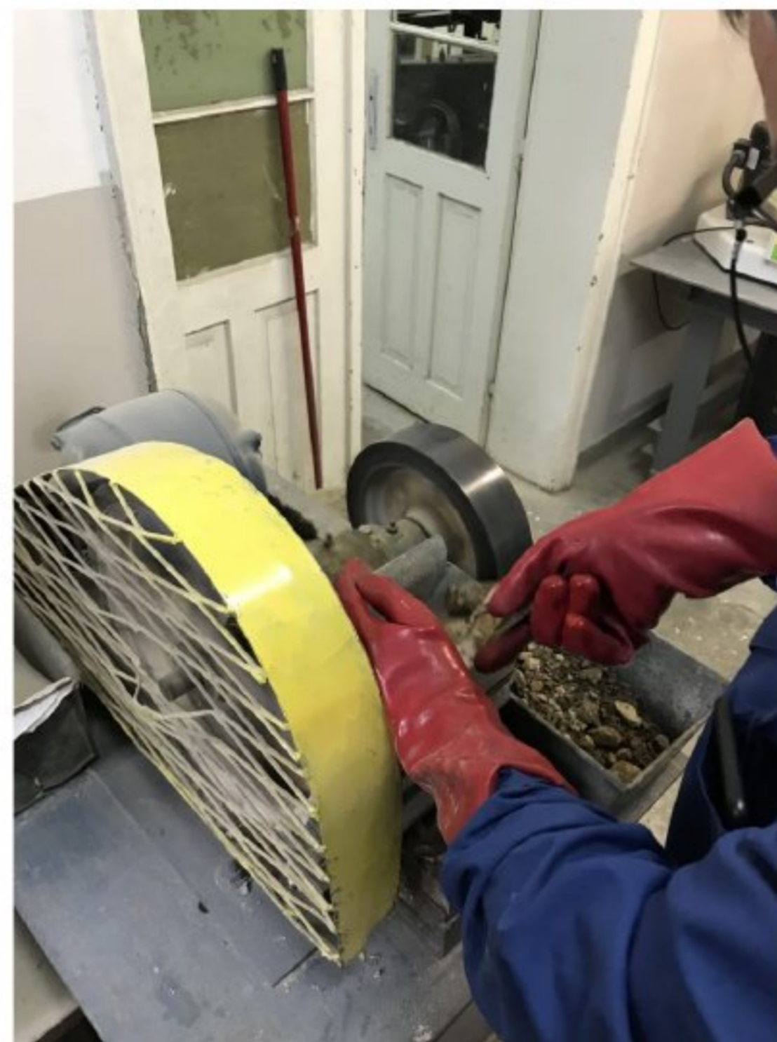
Слика 48 Уситњавање материјала на чељусној дробилици
