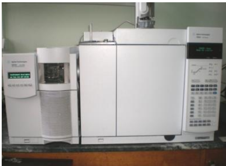
Slika 24. Gasni hromatograf sa masenim spektrometrom (Stojanović, 2017).
