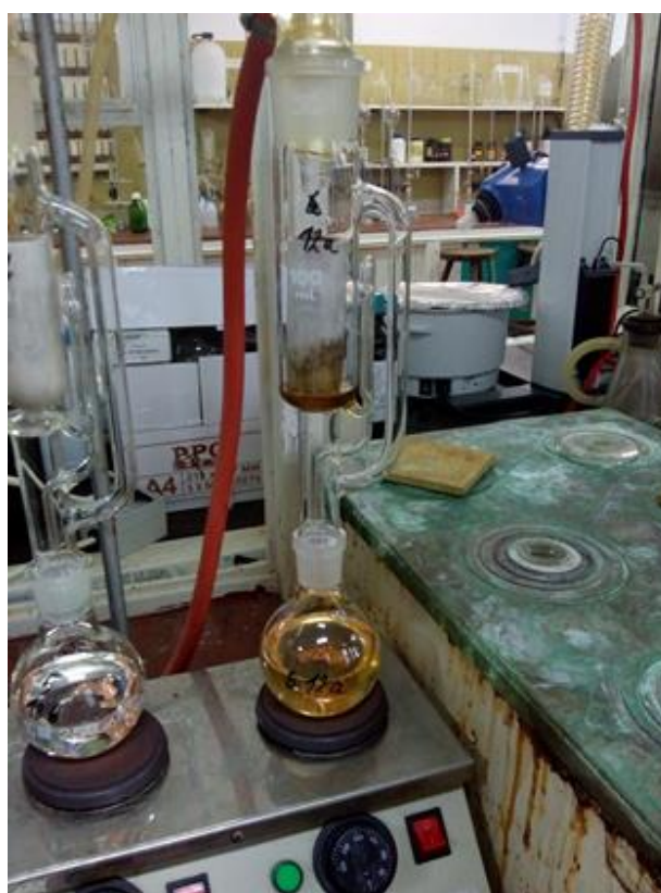
Slika 44. a) Šema Soxhlet ekstrakcije (Schwarzbauer i Jovančičević, 2020, modifikovano); b) ekstrakcija bitumena na uzorku istočne Hercegovine.
