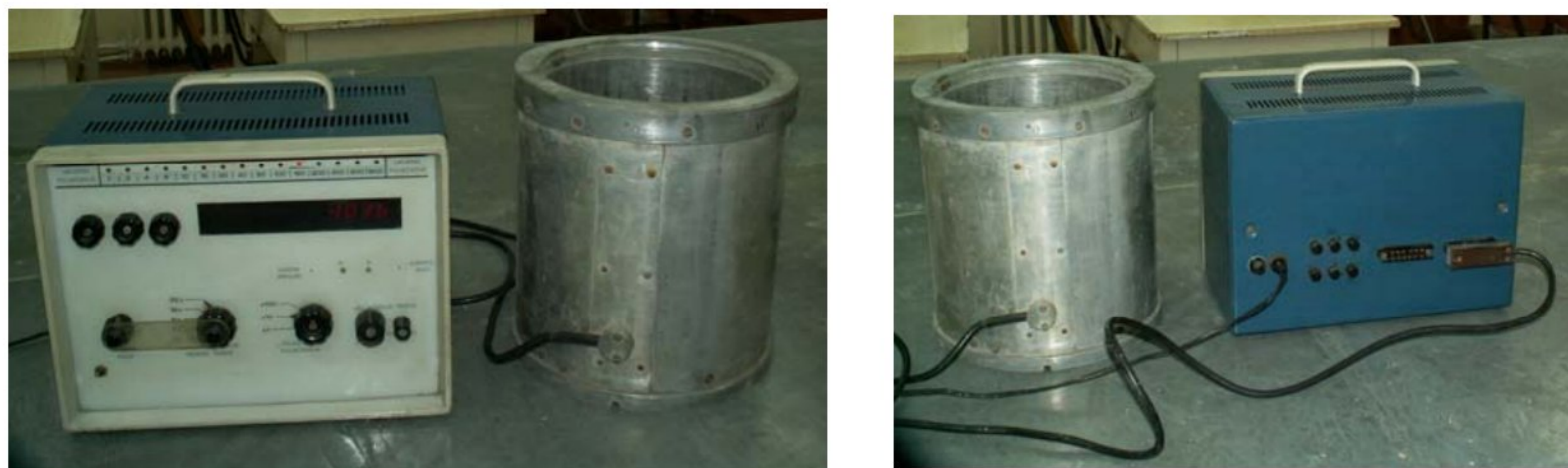
Слика 5. Систем за одређивање хоризонталних напона током испитивања узорка у едометарском апарату велике размере
