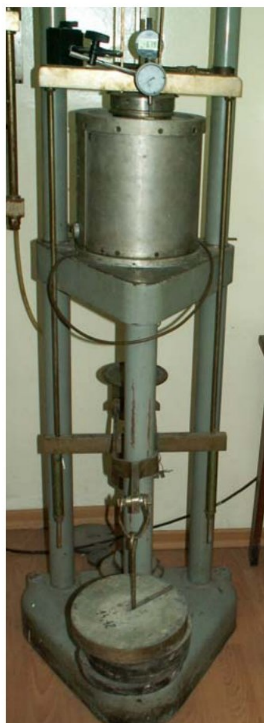
Слика 4. Модификовани цилиндар и систем за оптерећење
