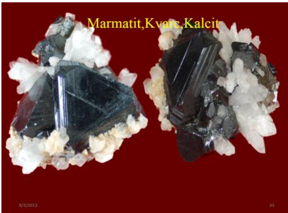
Slika 4.12: Sfalerit (marmatit) kao kristal druzi, iz rudnika u Starom Trgu, u asocijaciji sa kvarcom i kalcitom
