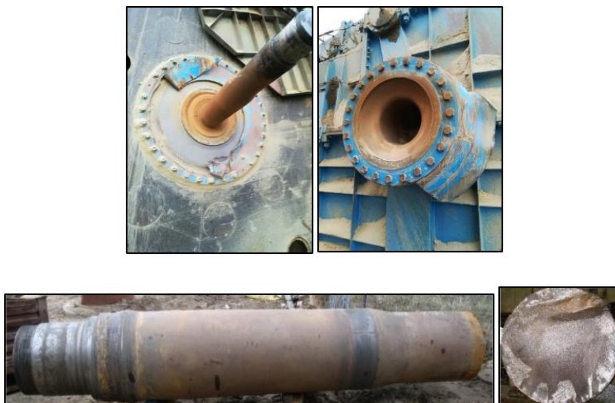
Slika 2.1. Problematika pogona rotora bagera SRs 2000 (bager I)
