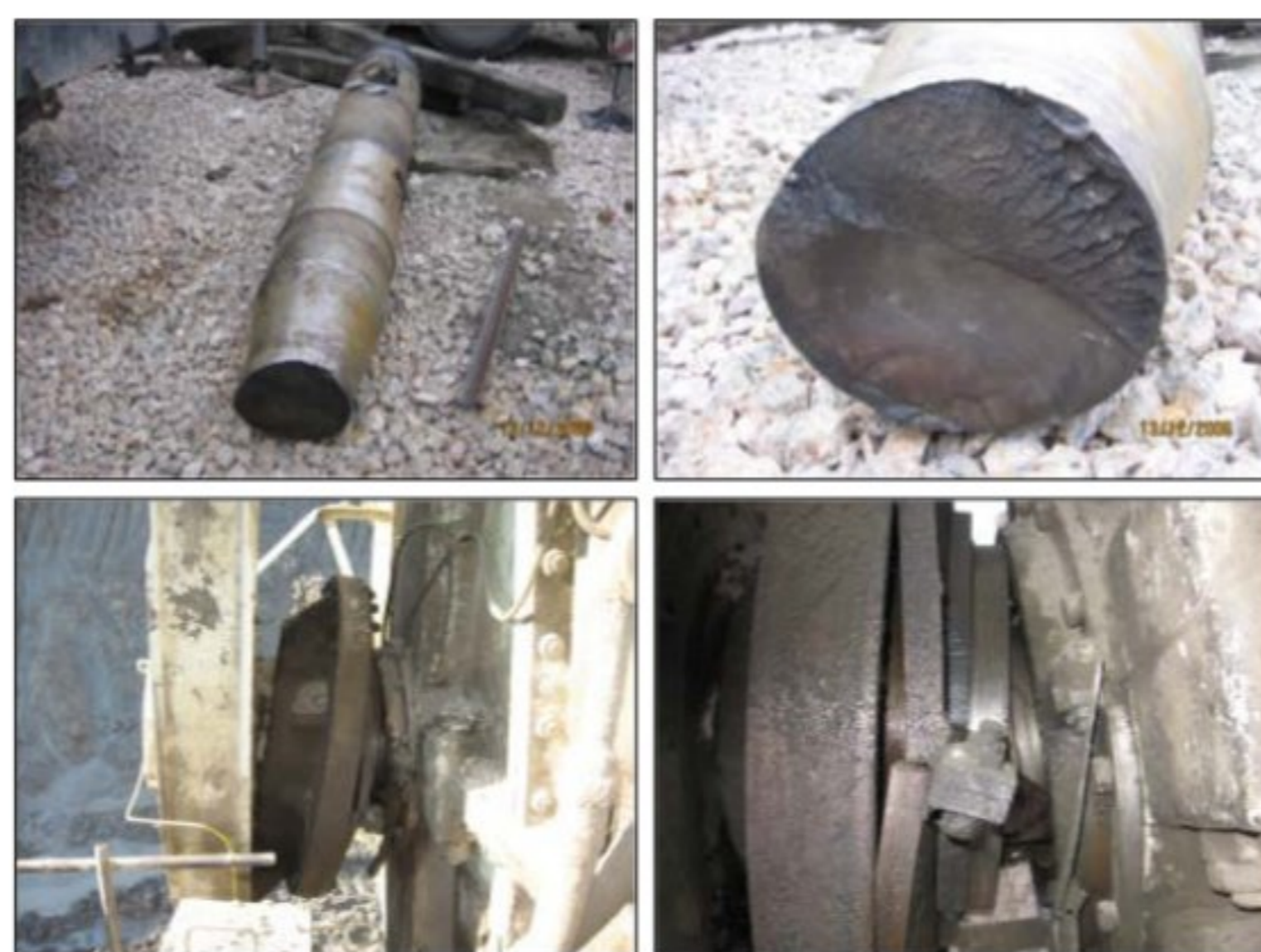
Slika 2.6. Lom osovine rotora i havarija male membrane
