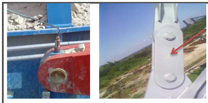
Slika 7.2. – Položaj mernih traka na bageru
