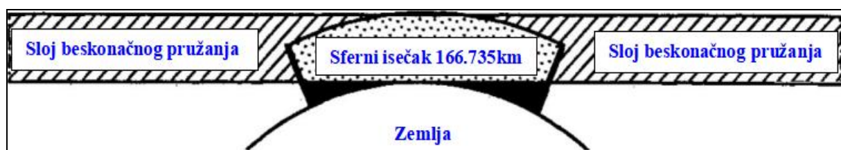
Slika 1. Geometrija sfernog isečka u odnosu na horizontalni sloj beskonačnog pružanja (LaFehr, 1991b)
