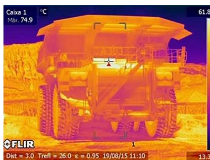
Slika 2. Termogram kamiona (kamionski transport) na površinskom kopu [15]
