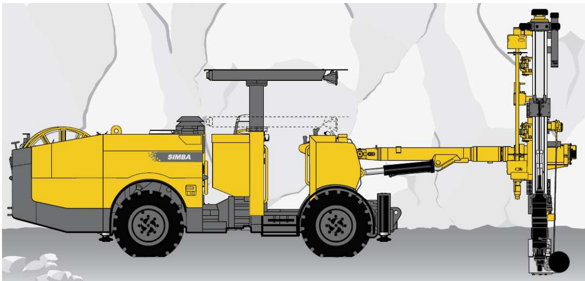
Slika 7. 1. Garnitura za bušenje dugačkih bušotina SIMBA S7D
