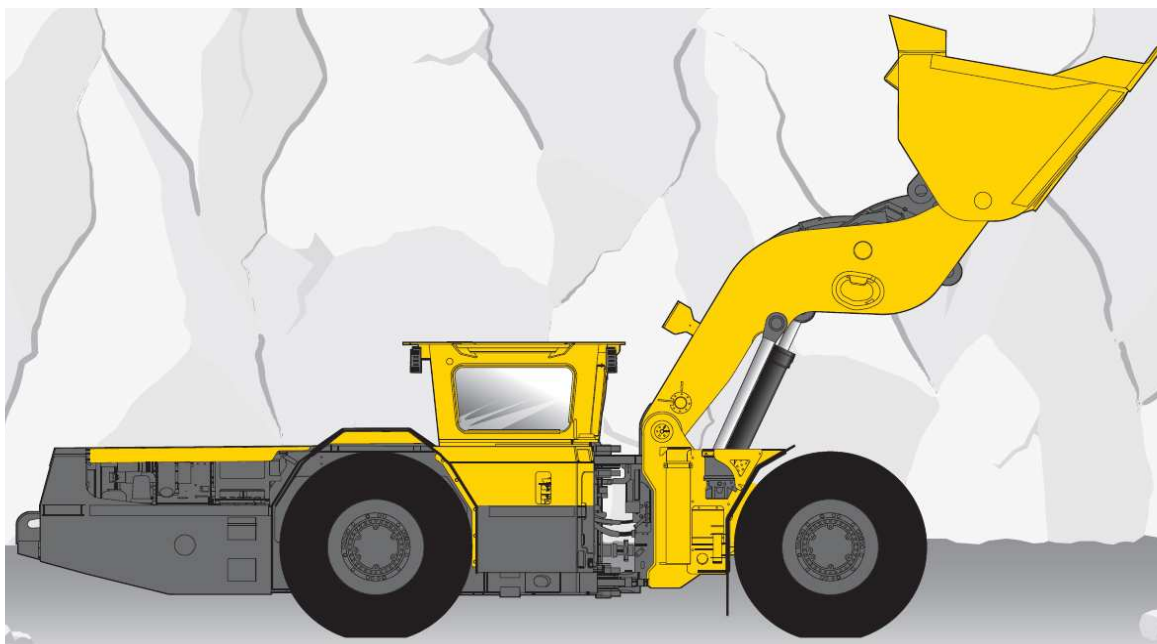
Slika 7. 3. Jamski utovarač Atlas Copco Scooptram ST7
