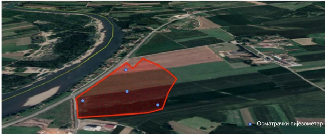
Слика 5.6. Предлог постављања пијезометара ради праћења квалитативних и квантитативних промена подземних вода у непосредној близини постројења
