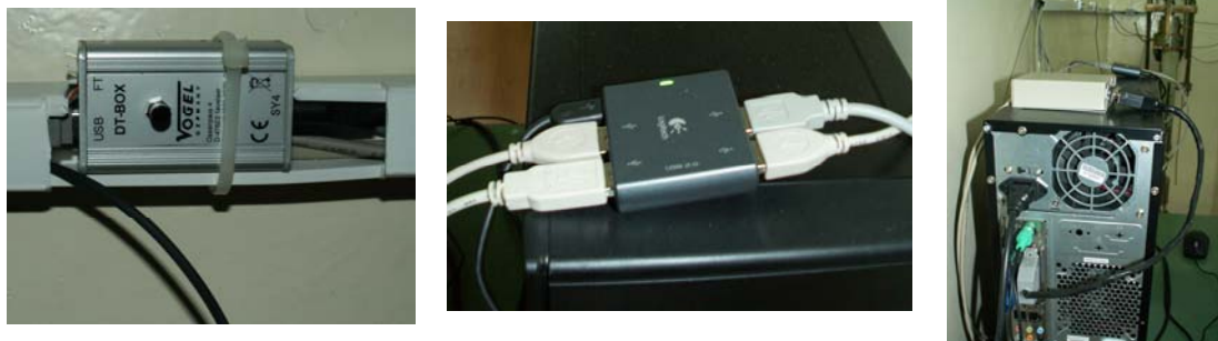
Slika 7.14. Povezanost sistema za akviziciju mernih vrednosti
