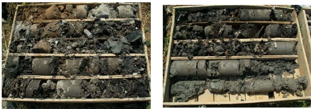
Slika 4.16 Komunalni otpad iz istražne bušotine na deponiji Ada Huja
