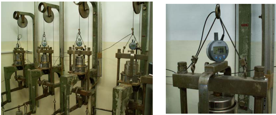
Slika 7.10. Edometarski aparati sa dimenzijama prstena D = 100 mm i h = 40 mm – RGF Beograd
