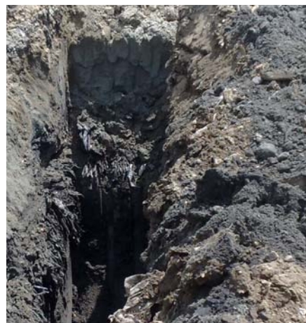
Slika 3.6. Određivanje zapreminske težine komunalnog otpada na terenu
