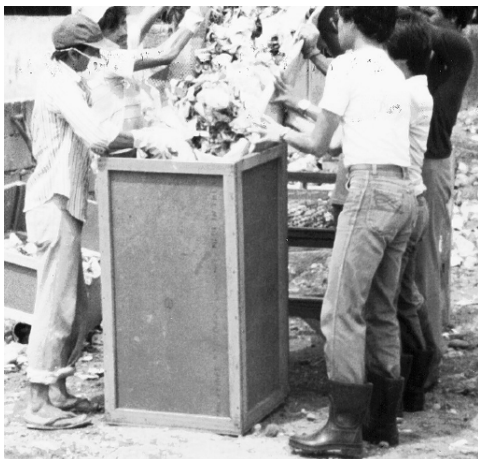
Slika 3.6. Određivanje zapreminske težine komunalnog otpada na terenu
