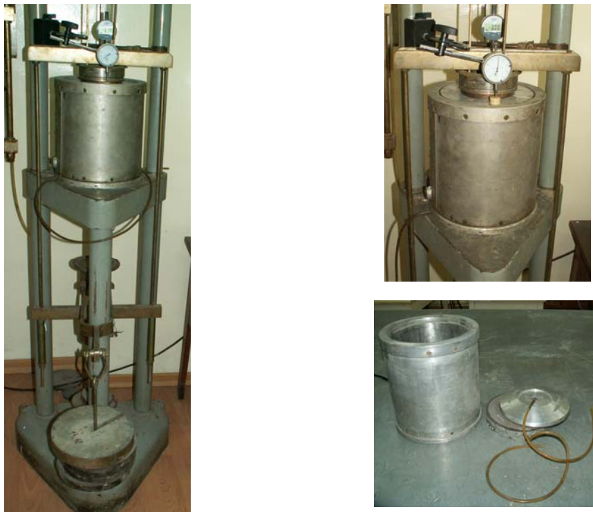
Slika 7.12. Izgled edometarskog aparata i sistema za opterećenje
