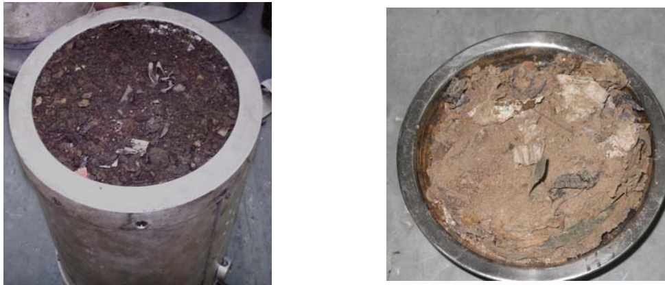
Slika 7.17. Formiranje uzorka u velikoj edometarskoj ćeliji – a); izgled uzorka nakon obavljenog sušenja – b)
