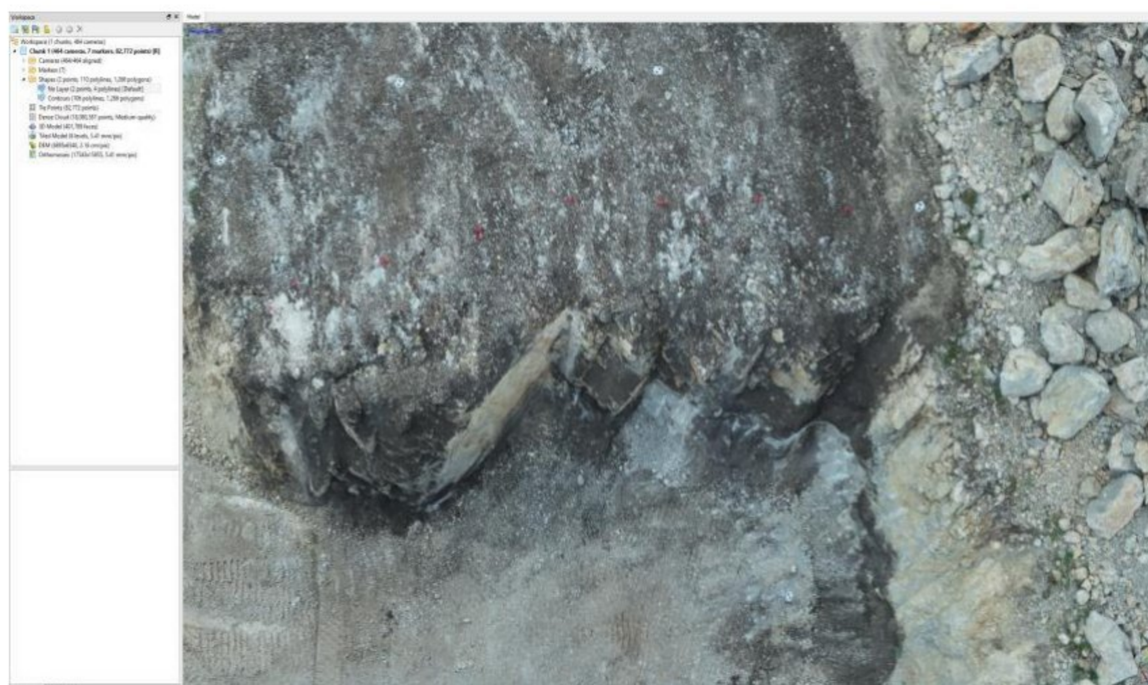
Sl. 8. Prikaz neravnina na čelu etaže kroz model sa preklopljenim ortofoto snimkom
