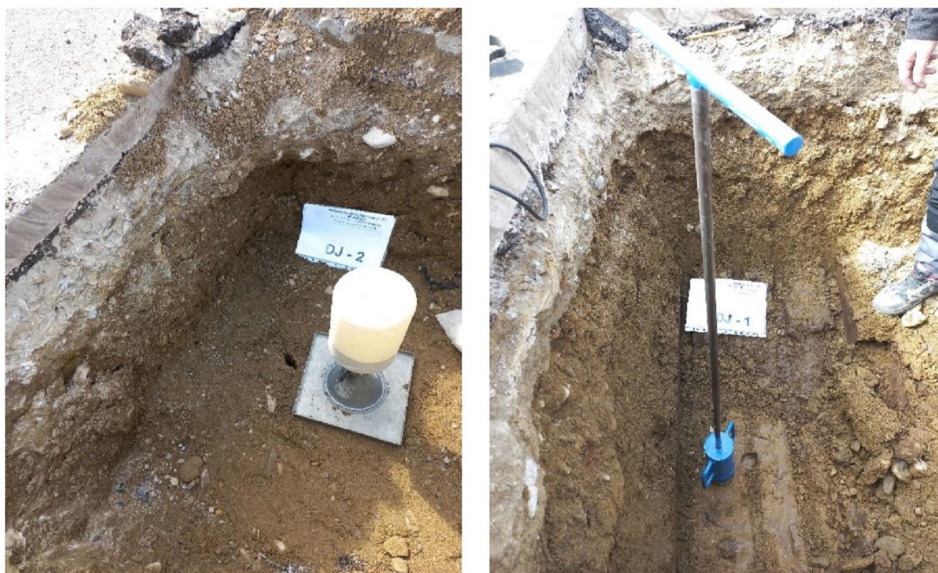
Slika 3.7. Određivanje zapreminske mase na terenu – lokacija objekta Autoput E-80: Niš (Merošina) - Pločnik (Beloljin) a) uređaj sa konusom; b) uređaj sa tankozidnim cilindrom;
