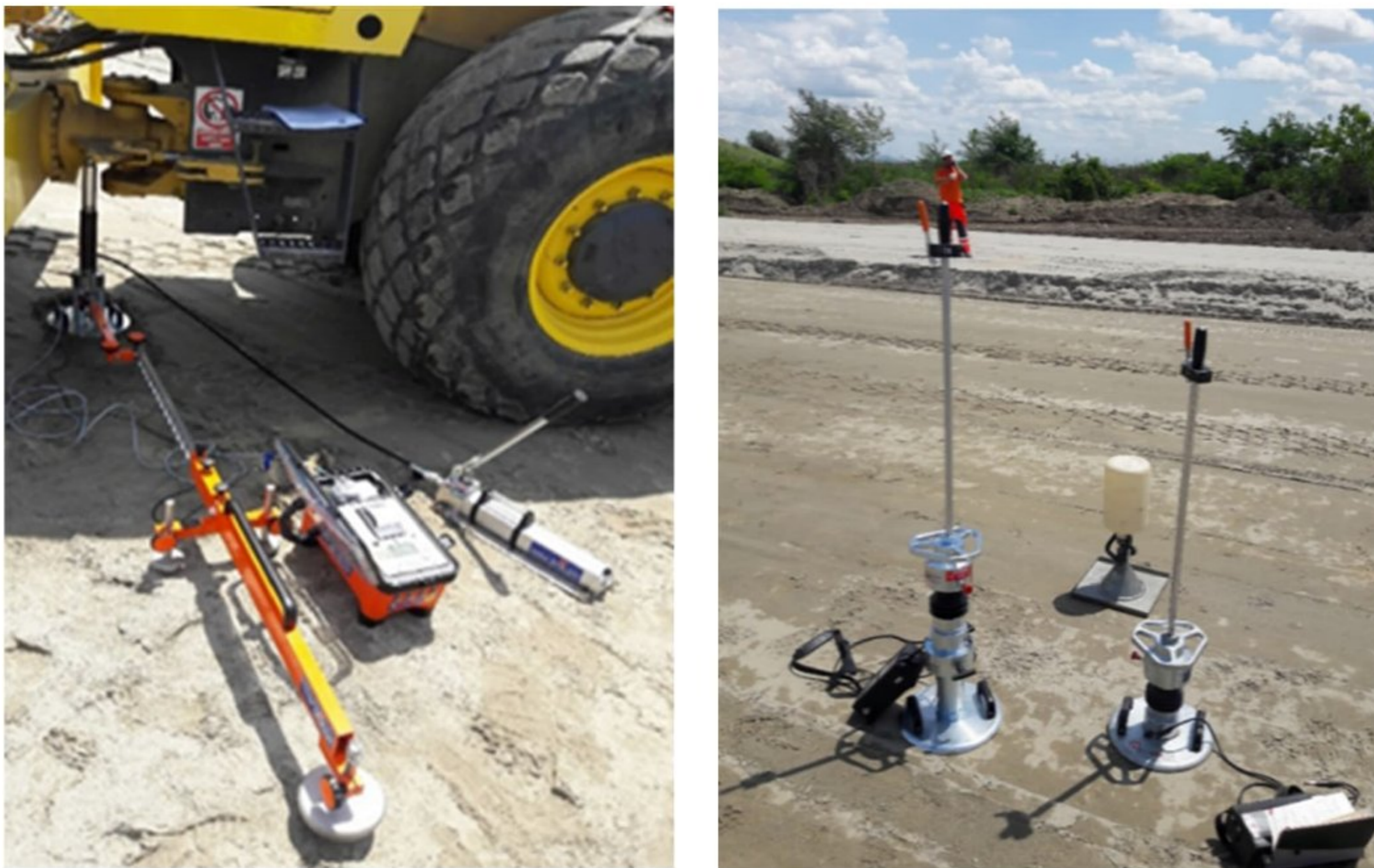
Slika 4.20. Korišćena oprema za određivanje parametara E_{v1} - E_{v2} , E_{vd} i CBR_{dt} pripremljenog sloja posteljice na lokaciji objekta Petlja Batajnica (Autoput E75) u Beograd
