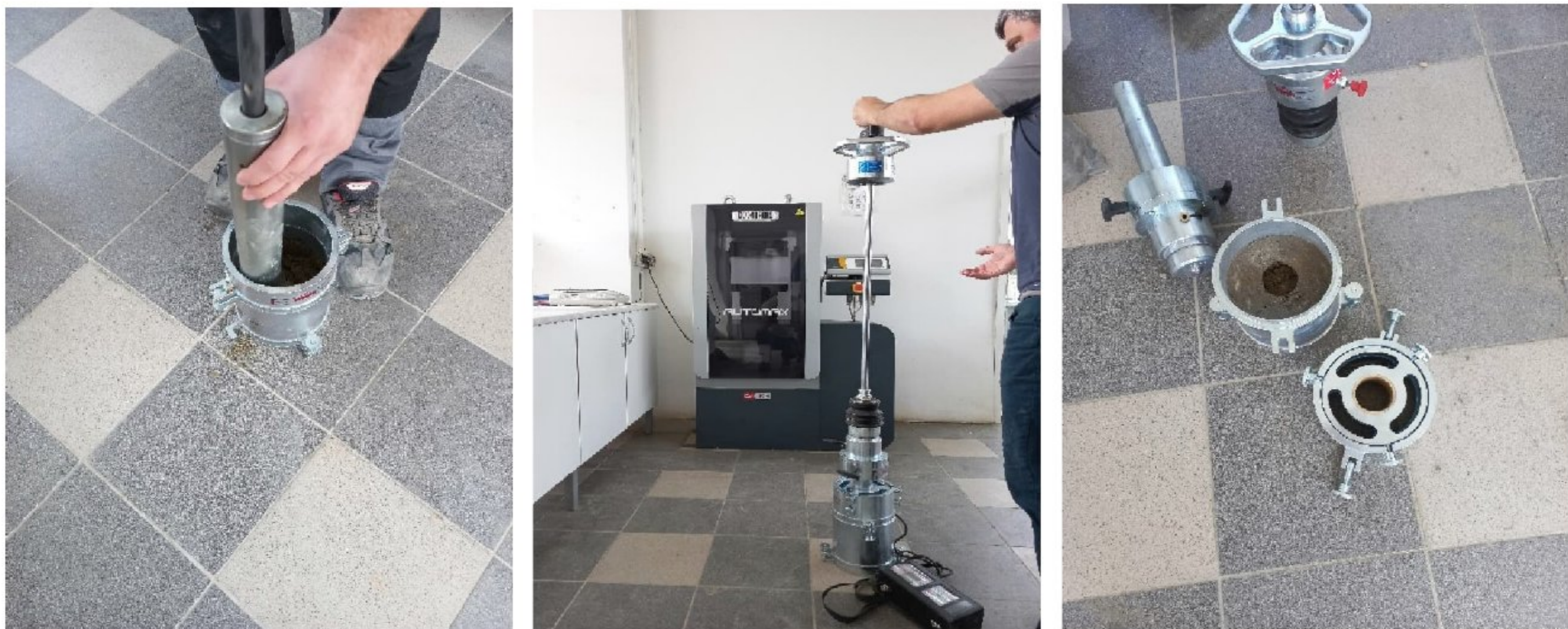
Slika 4.17. Pojedinačni koraci pripreme uzoraka i postupka ispitivanja dinamičkog CBR dl u laboratoriji TPA u Beogradu
