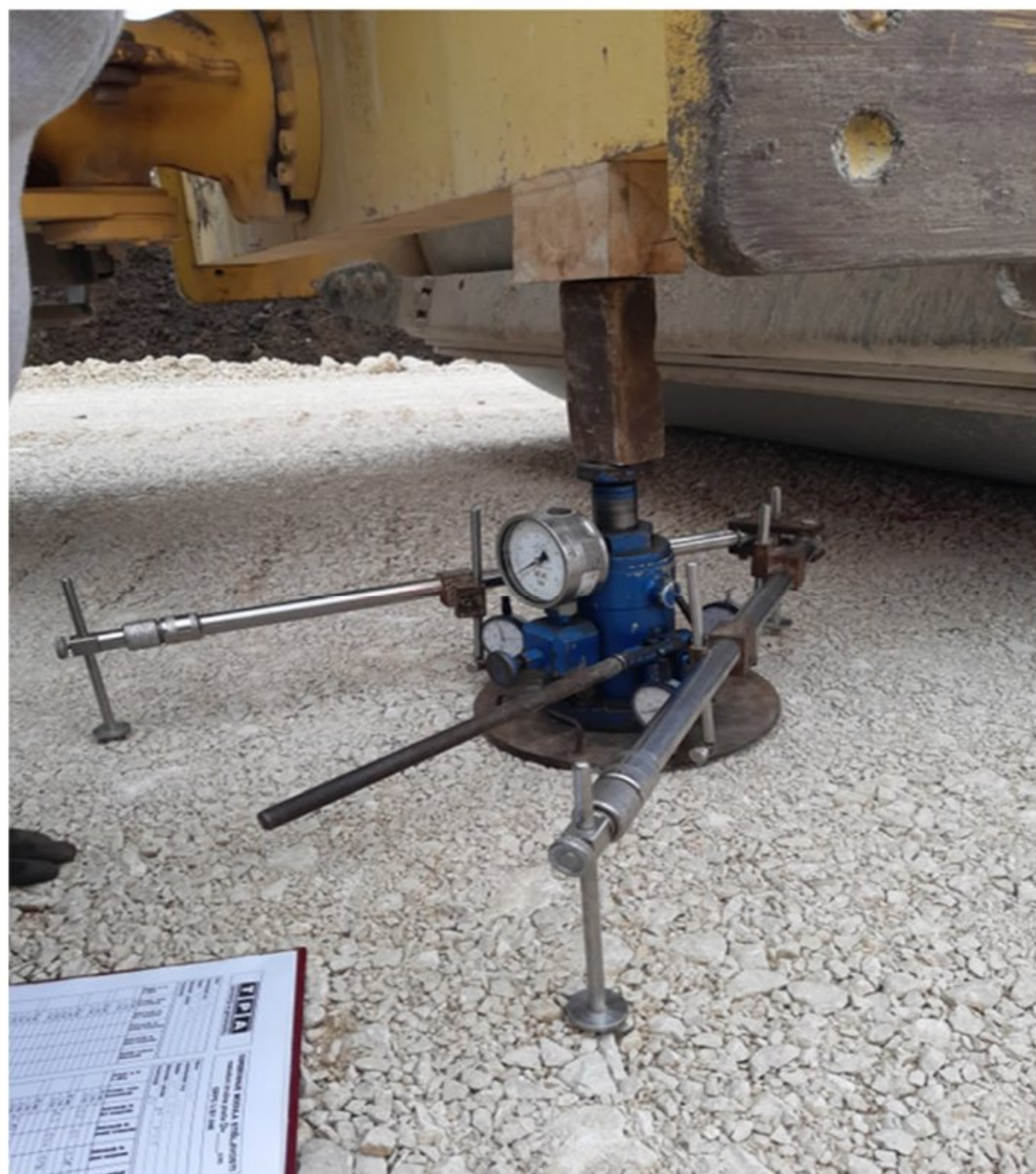
Slika 3.13. Merenje modula stišljivosti - M_s , sloj posteljice na lokaciji izgrađenog državnog puta Ib reda broj 22
