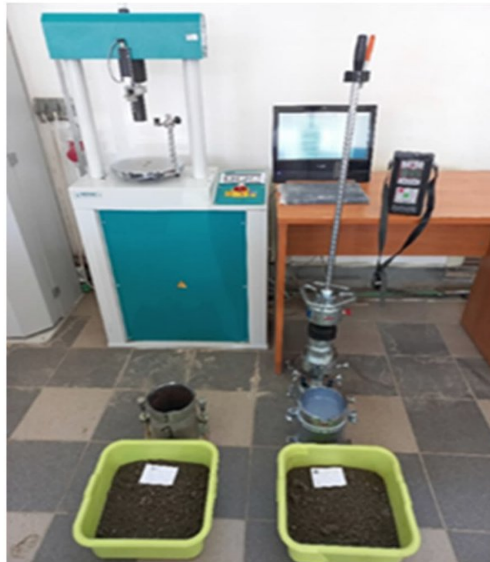
Slika 4.15. Uređaji za određivanje statičkog CBR-a i dinamičkog CBR dt , TPA laboratorija u Beogradu
